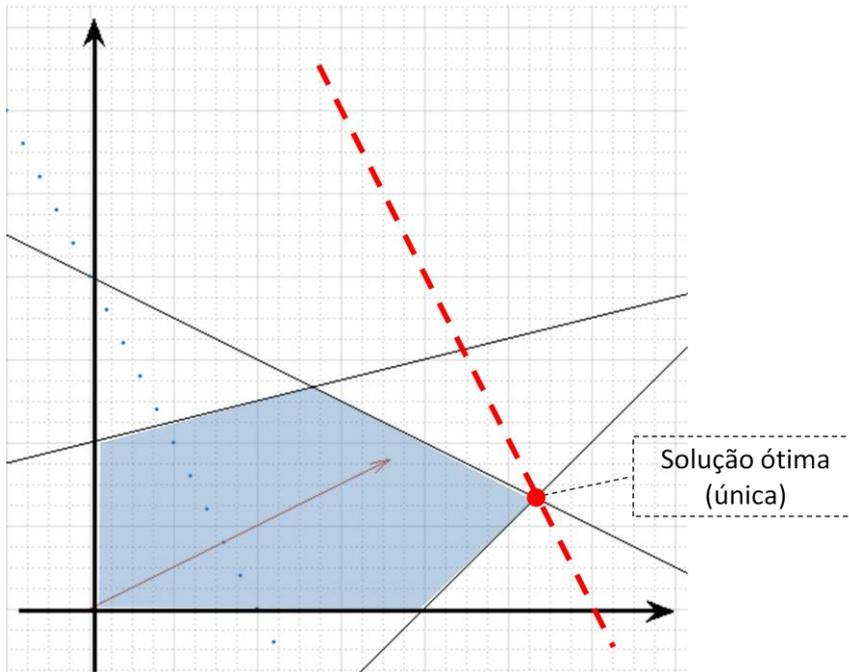
Matlab:  $x = -4:0.1:4$ ;  $y1 = (1/4)*(8 - 2*x)$ ;  $y2 = (1/4)*(4 + x)$ ;  $y3 = (-2 + x)$ ;  $z = (1/3)*(6 - 6*x)$ ;  $plot(x,y1,'k', x,y2,'k', x,y3,'k')$ ;  $hold on$ ;  $plot(x,z,'r')$ ;  $grid on$ ;  $axis square$ ;  $ylim([-1 4])$ ;  $xlim([-1 4])$ ;  $grid minor$ ;  $quiver(0, 0, 2, 1)$ ;
