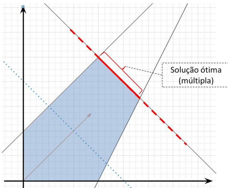
Matlab:  $x = -4:0.1:8$ ;  $y1 = (1/1)*(8 - x)$ ;  $y2 = (1/4)*(8 + 4*x)$ ;  $y3 = (-6 + 2*x)$ ;  $z = (1/1)*(4 - 1*x)$ ;  $plot(x,y1,'k', x,y2,'k', x,y3,'k')$ ;  $hold on$ ;  $plot(x,z,'r')$ ;  $grid on$ ;  $axis square$ ;  $ylim([-1 8])$ ;  $xlim([-1 8])$ ;  $grid minor$ ;  $quiver(0, 0, 3, 3)$ ;
