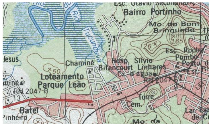
**FIGURA 4.5 – Parte de Carta Topográfica Antonina, na escala 1:50.000 (ilustração em escala aproximada)**
