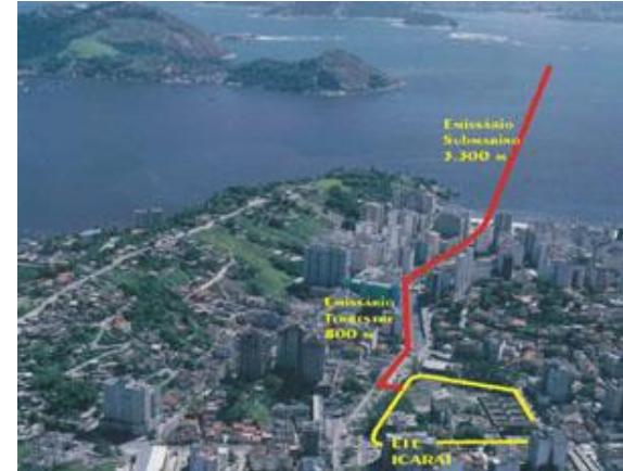
Novo SDO Icaraí em Niterói – emissário de 3.300 m dentro da Baía de Guanabara para uma vazão de  $0,95 \text{ m}^3/\text{s}$  de esgoto
