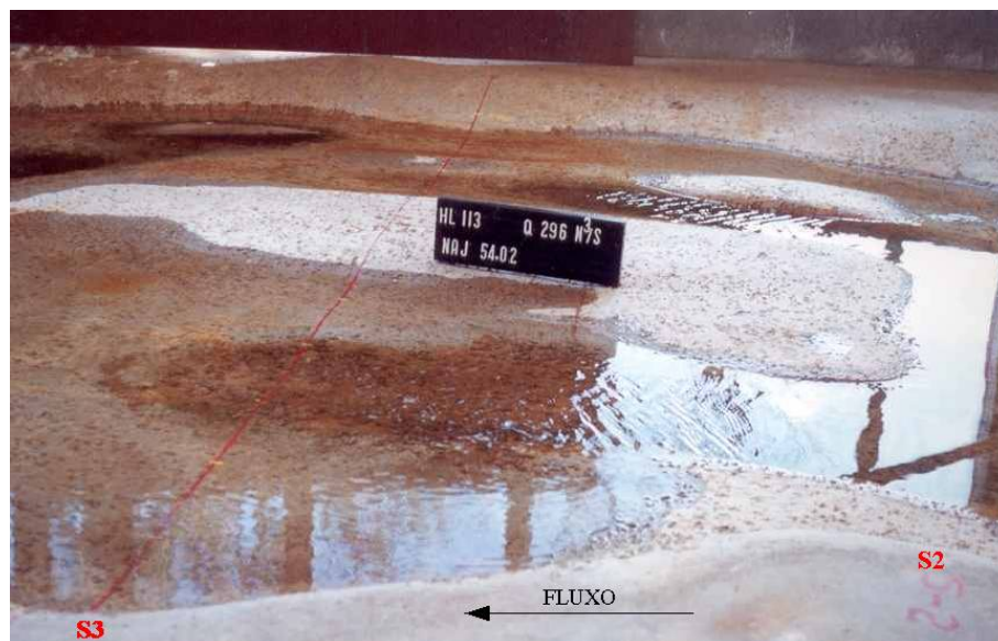
FIGURA 7.7 – DETALHE DA REGIÃO DE CORREDEIRAS — ENSAIO 1a
