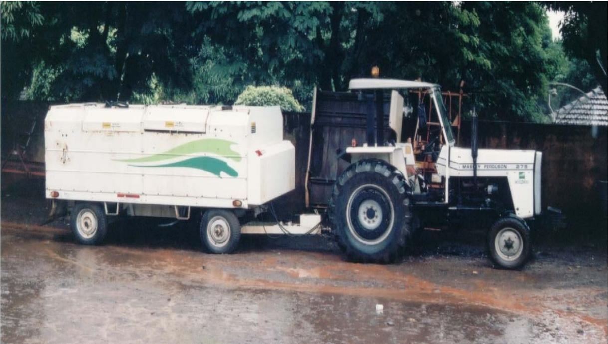
FIGURA 3.13 – CAMINHÃO COMPARTIMENTADO UTILIZADO NA COLETA SELETIVA
