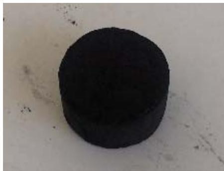
FIGURA 18 – BRIQUETE FEITO EM LABORATÓRIO UTILIZANDO RESÍDUOS
