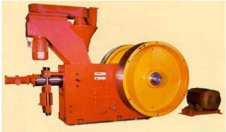
FIGURA 16 – BRIQUETADEIRA DE PISTÃO MECÂNICO
