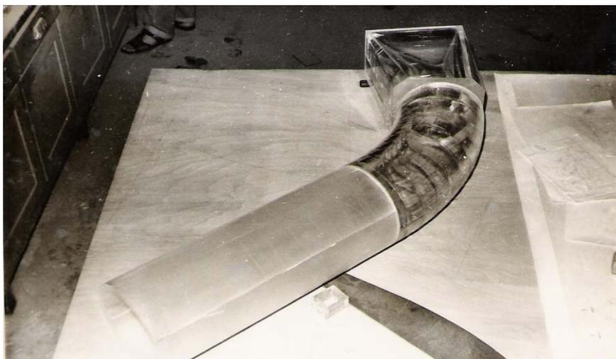
**Figura 6.25 – Modelo físico da UHE Itaipu – curva inferior.**
