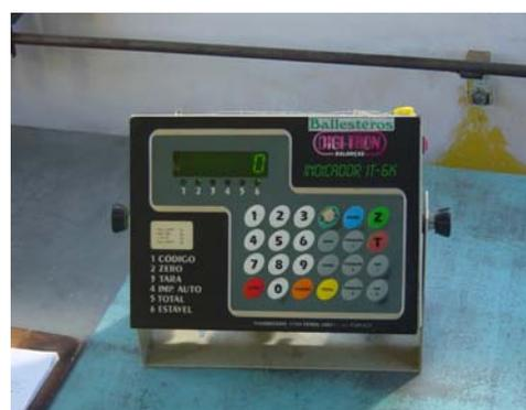
b) Detalhe do display de 6 dígitos utilizado na operação da balança
