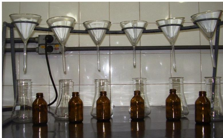
Figura 17 - Filtração das amostras
