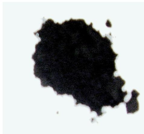
Figura 11 - Sobras do Processo de Fabricação de Carvão Ativado - ADS3 moído
