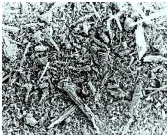
Figura 9 - Carvão ativado de madeira moído - imagem obtida por microscopia eletrônica cedida por Indústrias Químicas Carbomafra S/A
