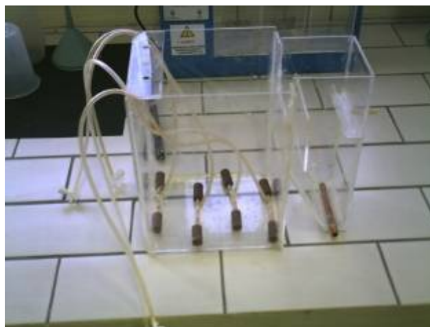
FIGURA 22- VISUALIZAÇÃO DAS PEDRAS POROSAS E SUA INSTALAÇÃO NO TANQUE DE AERAÇÃO DO SISTEMA DE BANCADA
