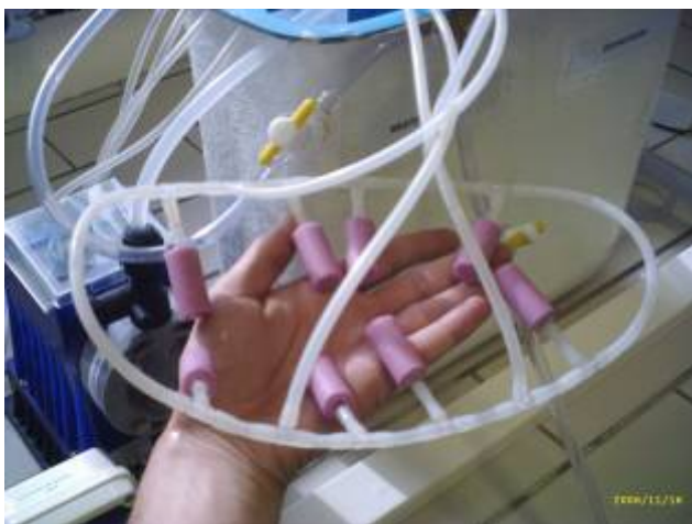
FIGURA 22- VISUALIZAÇÃO DAS PEDRAS POROSAS E SUA INSTALAÇÃO NO TANQUE DE AERAÇÃO DO SISTEMA DE BANCADA
