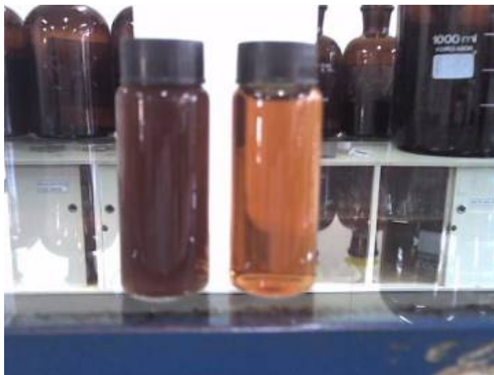
FIGURA 26 - AMOSTRA DE LIXIVIADO BRUTO E TRATADO PARA ENSAIO DE TURBIDEZ EM A/M = 0,15 \text{ d}^{-1}
