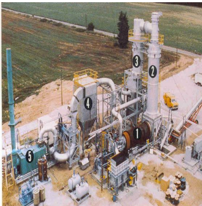
FIGURA 2.9-INSTALAÇÃO TÍPICA PARA INCINERAÇÃO DE RESÍDUOS
