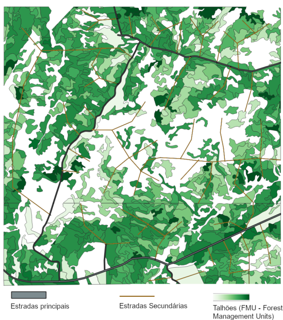
FIGURA 5 – EXEMPLO DE REDE VIÁRIA DE ACESSO À TALHÕES
