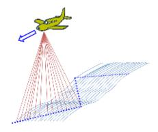
A cada descida do satélite uma faixa é varrida. A largura desta faixa depende da órbita, da altura à que se localiza o satélite e da abertura máxima permitido pelo sistema de varredura, ou seu campo de visão (Field of View – FoV). O FoV é controlado pelo movimento máximo do espelho. Geralmente se mantém um ângulo estreito para garantir maior resolução espacial.
