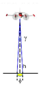
A consequência da simplificação do plano da imagem sob forma de uma malha regular finita, cujos elementos têm um tamanho fixo e constante (pixels), é que toda a energia proveniente da área coberta pelo detector (pixel) é armazenada com um único número.
