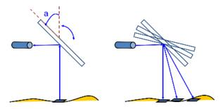
Aqui surge outro problema. Como a plataforma se desloca sem parar, esta linha não é perpendicular à linha de voo, mas sim inclinada e o movimento do espelho, ida e volta, pode produzir um padrão zig-zag na superfície varrida.
