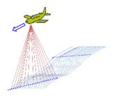
A solução encontrada é usar vários detectores, não tantos como em um imageador de quadro, mas suficientes para cobrir a faixa deixada em branco. Os detetores são deslocados no sentido transversal à trajetória da plataforma, de modo que uma faixa larga é varrida.
