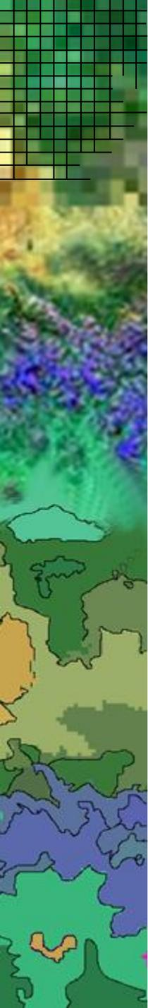
Confira, nas imagens do vermelho e do infravermelho próximo (NIR) a alta absorção da vegetação no visível e a alta reflexão no NIR. As manchas claras na segunda imagem mostram alta reflexão no infravermelho próximo e baixa no visível, logo devem ser vegetação.
