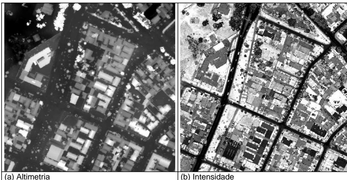
Figura 2 – Imagens oriundas dos dados do laser scanner
