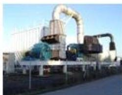
A Dessorção Térmica é um processo que tem como objetivo o tratamento de solos contaminados com gasolina, óleo diesel, querosene, entre outros, reduzindo sua concentração a níveis que permitam a disposição do solo em seu local de origem ou em uma nova utilização. A Dessorção Térmica é mais uma solução da Essencis com foco em Sustentabilidade.
