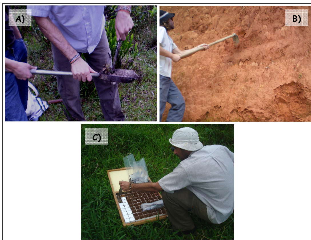
Figura 14 A) coleta com o auxílio de trado holandês; B) coleta realizada em corte de estrada; C) amostras organizadas em pedocomparador.
