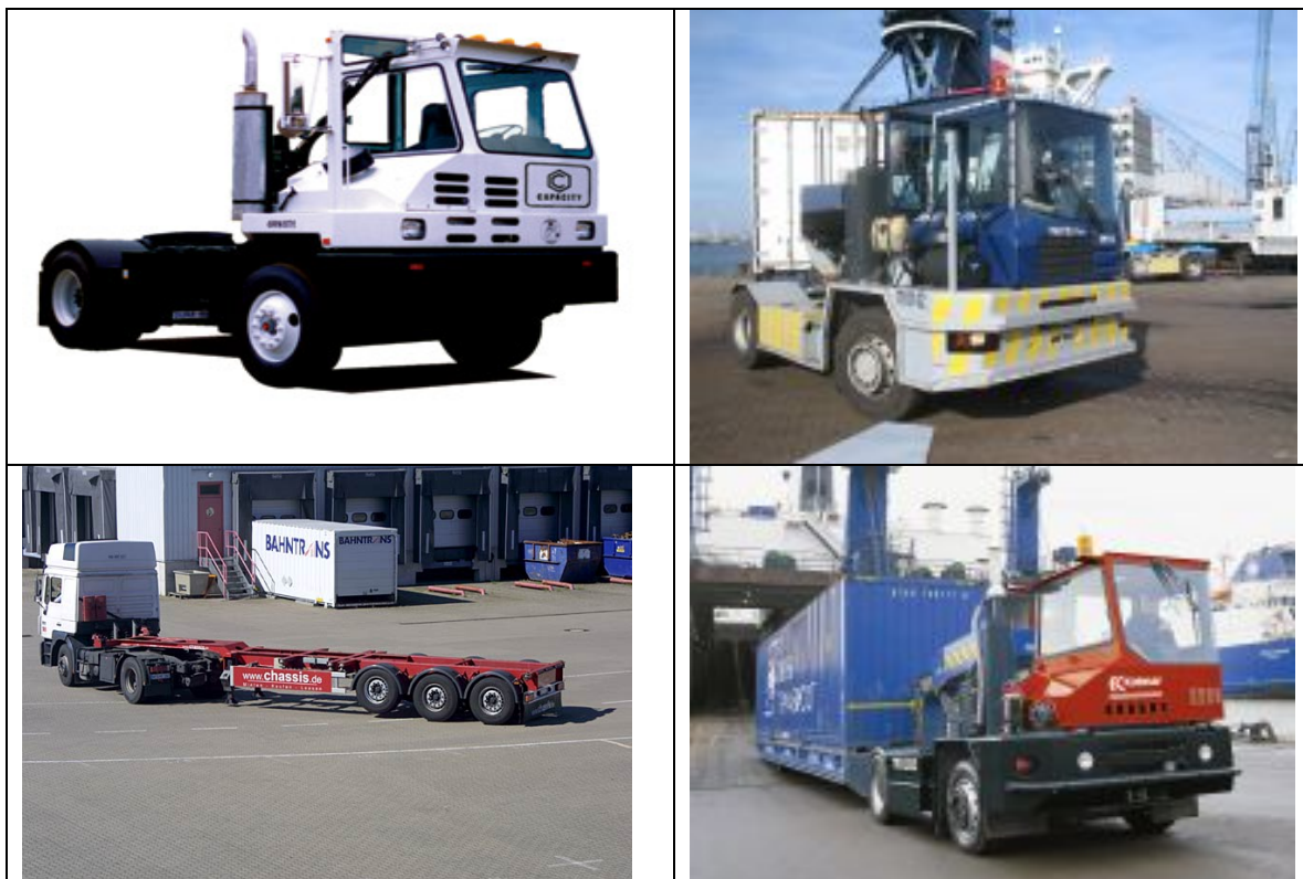
Figura 2.21: Tractor-trailer's e tractor-chassis que serão utilizados para movimentação de contêineres no Pátio (Fonte: ZPMC - Shanghai Zhenhua Port Machinery; www.zpmc.com )
