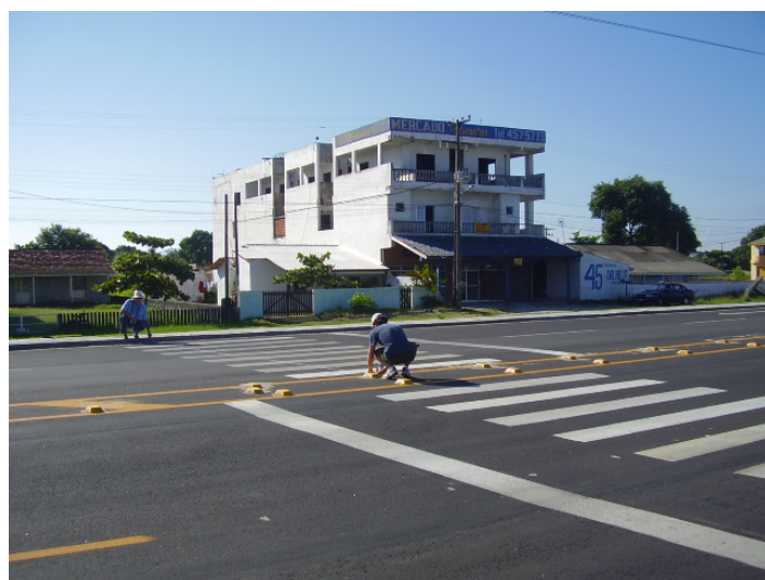
Figura 5.3.14: Medida da largura da pista em trecho duplicado (PR-412, Ipanema) Fonte: Mello 26/03/2007
