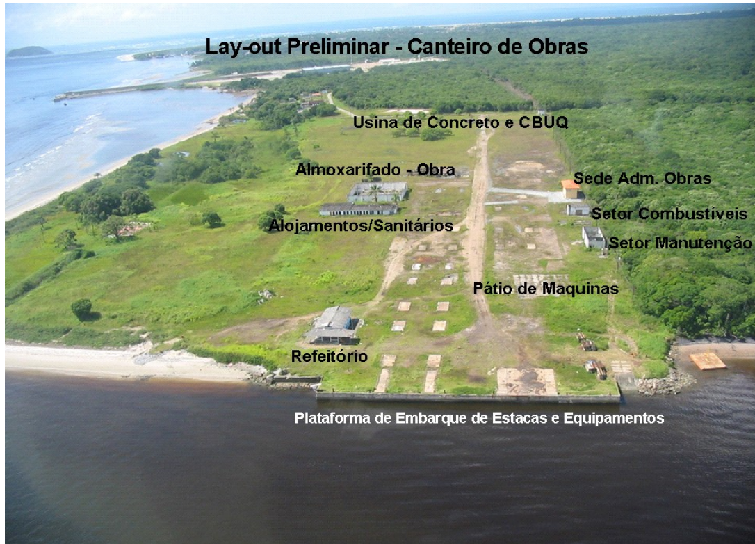
Figura 16: Layout do canteiro de obras do TCPP
