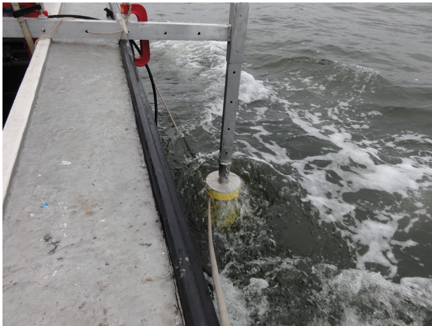
Figura 6-78 – Equipamento Perfilador Acústico - ADCP instalado na porção lateral de embarcação.
