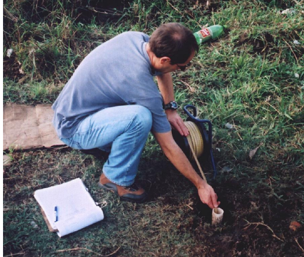
Figura 6-57 - Obtenção da medida do nível da água do poço de monitoramento.
