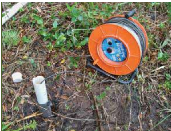
Figura 6-82: Obtenção da medida do nível da água do poço de monitoramento.
