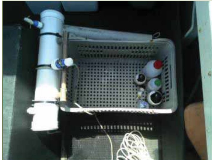
Figura 6-74: Garrafa horizontal de Van Dorn e frascos utilizados para acondicionamento de amostras no ponto MP2. (EnvEx, 2013).
