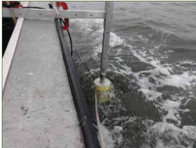
Figura 6-45: Equipamento Perfilador Acústico - ADCP instalado na porção lateral de embarcação
