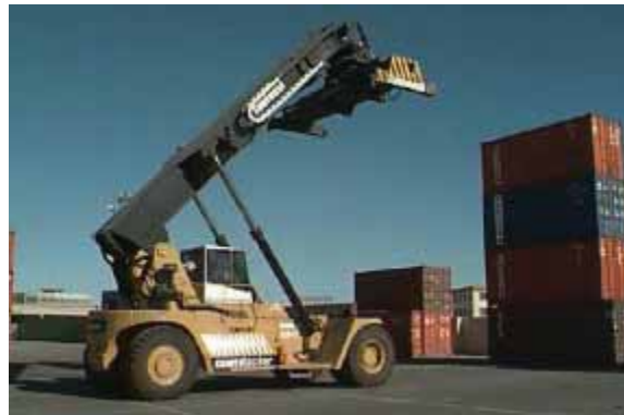
Figura 3-2 - Empilhadeira de contêineres.
