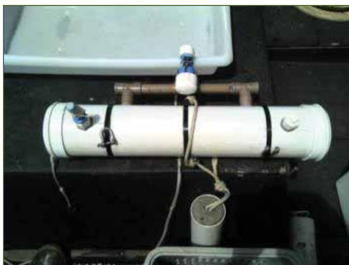
Figura 6-73: Garrafa horizontal de Van Dorn utilizada nas coletas nos pontos MP1 e MP2. (EnvEx, 2013).
