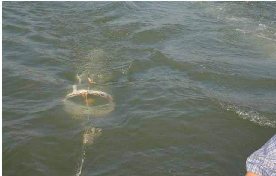
Foto 6-34 - Amostragem de ovos e larvas de peixes rede de ictioplâncton cônico-cilíndrica nas áreas ADA e AID do empreendimento Melport.
