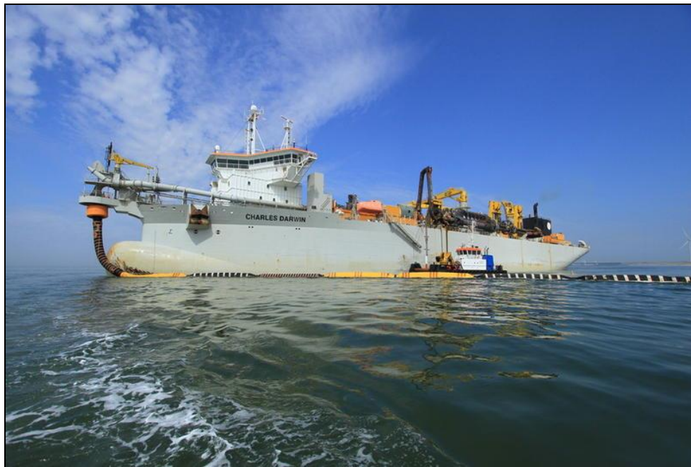
Figura 23. Dragas autotransportadora Charles Darwin utilizada durante a dragagem de aprofundamento do Porto de Itajaí, em 2011, com cisterna de capacidade de 30.500 m 3 . Fonte: jandenul.com.
