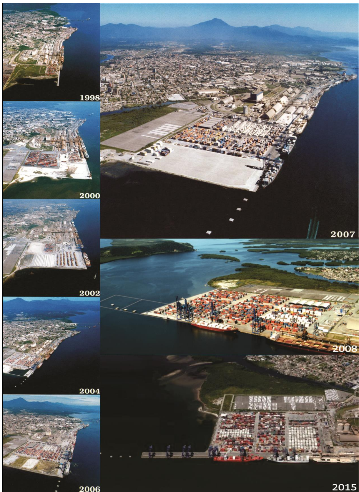
Figura 6. Imagens aéreas que mostram a evolução da ampliação da retroárea e cais leste do Porto de Paranaguá.
