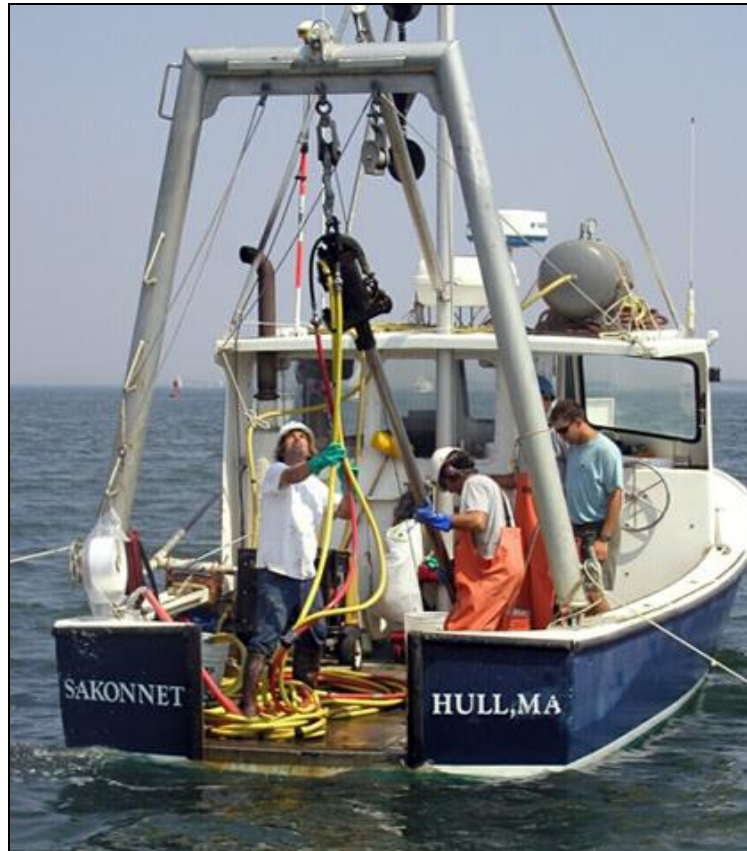
Figura 258. Ilustração de uma embarcação preparada para a amostragem de sedimentos em águas rasas, utilizando a metodologia de vibracore. Fonte: CR Environmental.
