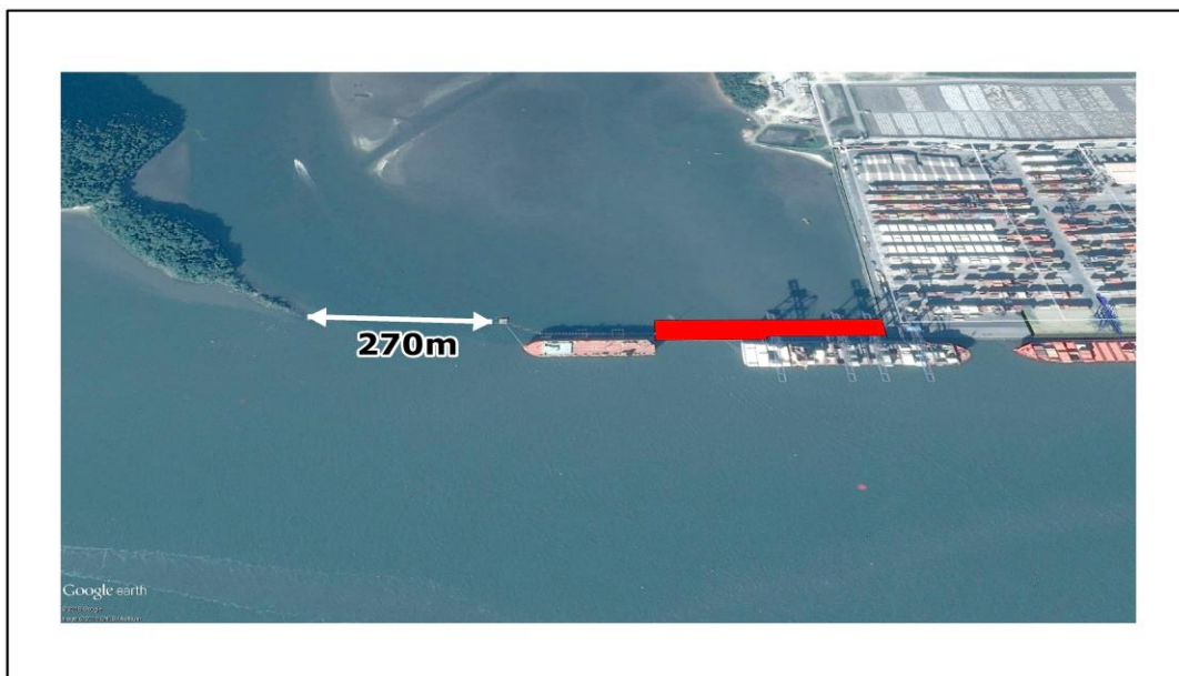
Figura 621. Ampliação do cais leste com a diminuição da seção livre do canal da cotinga para 270 metros.
