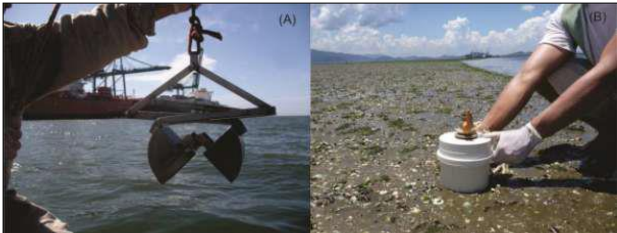
Figura 363. Equipamentos utilizados nas coletas: A) busca fundo do tipo van Veen e B) amostrador cilíndrico de PVC.
