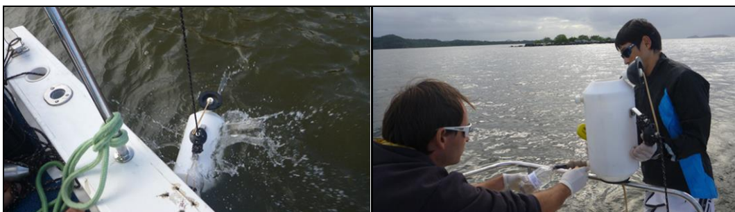
Figura 300. Garrafa do tipo van Dorn e envasamento das amostras em frascos devidamente identificados.
