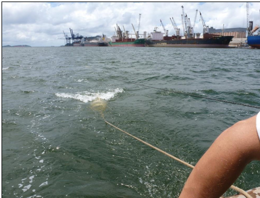
Figura 436. Rede para coleta de zooplâncton sendo arrastada em velocidade de 2 nós.
