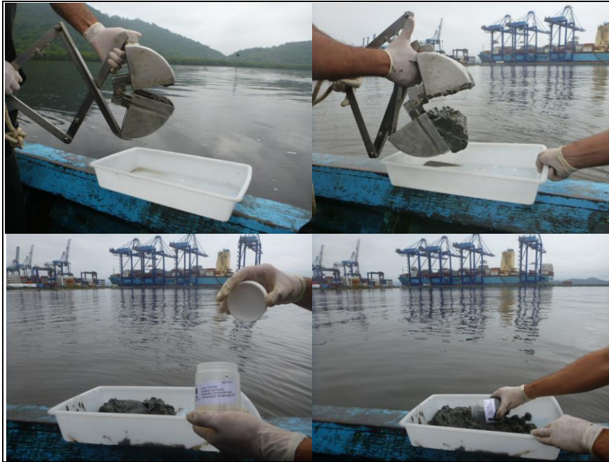
Figura 241. Amostrador do tipo van Veen utilizado na coleta de sedimento superficial.
