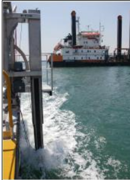
Figura 630. Equipamento instalado em embarcação com função de medir as partículas em suspensão na coluna d'água durante as atividades de dragagem. Fonte: Van Oord (2014).
