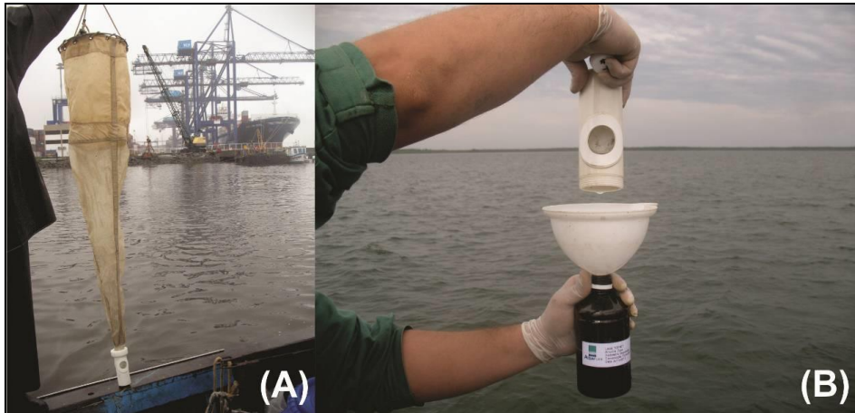
Figura 437. (A) Rede utilizada para a coleta de amostra da comunidade Zooplancônica e, (B) acondicionamento da amostra.
