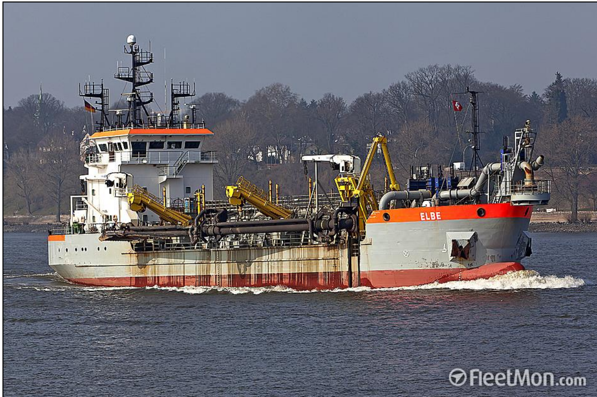
Figura 97. Draga Elbe, pré-selecionada para a execução da dragagem para as obras de complementação da ampliação do TCP.
