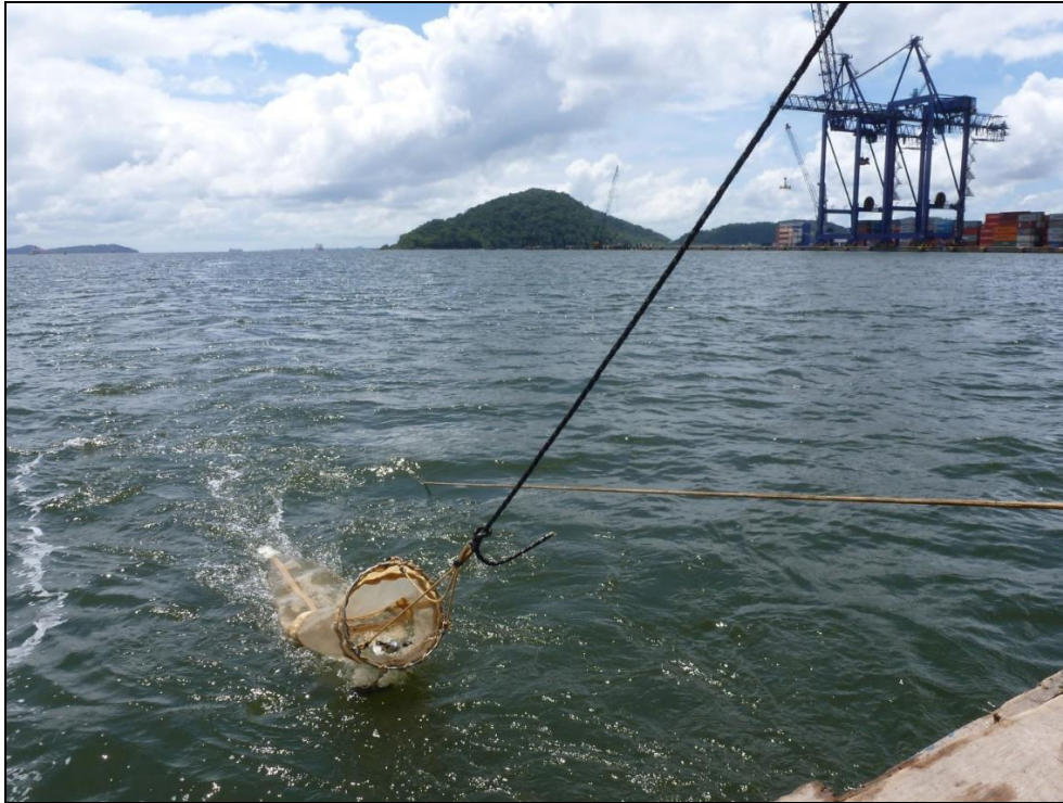
Figura 438. Arrasto da rede ictioplanctônica acoplada com fluxômetro para medir o volume de água filtrado.
