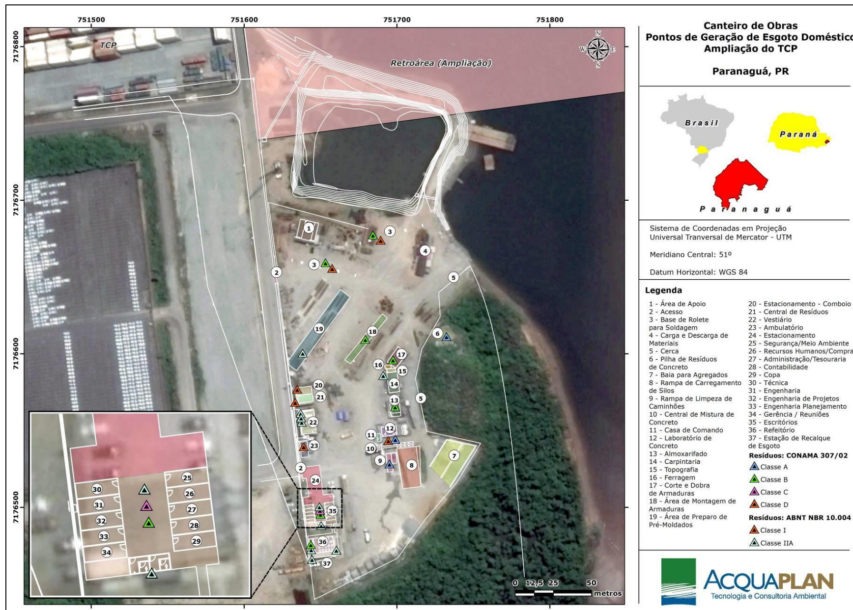
Figura 70. Layout do Canteiro de Obras a ser utilizado no Projeto de Ampliação e mapeamento dos pontos de geração de resíduos sólidos.
