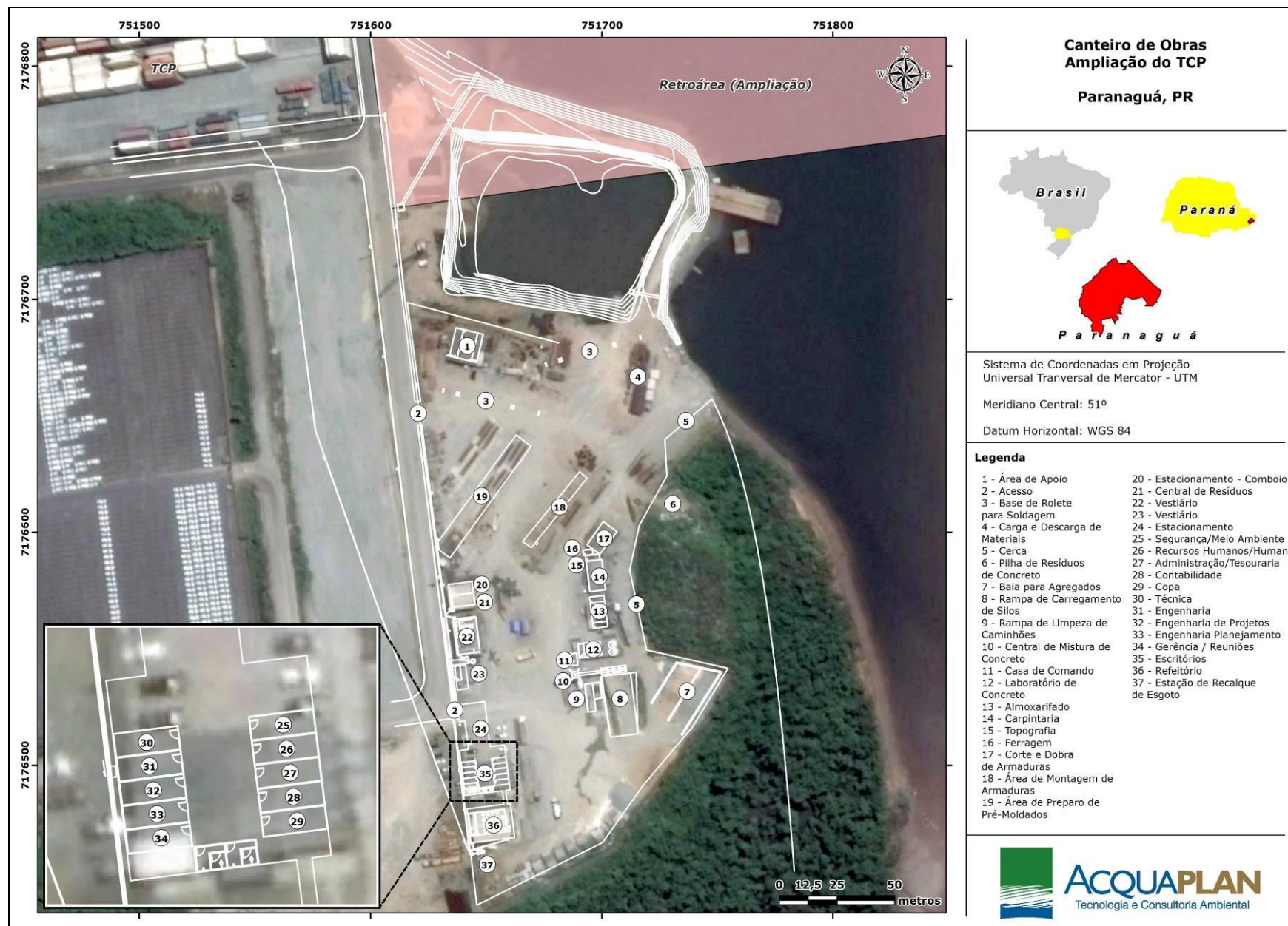
Figura 44. Canteiro de Obras previsto para as obras de ampliação do TCP.
