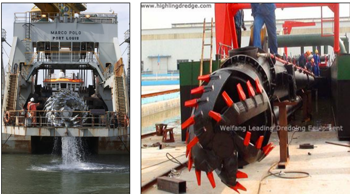
Figura 24. Detalhe da draga de sucção e recalque. Fontes: (E) Jandenu.com e (D) http://www.highlindredge.com/product.asp?leibie=73 .
