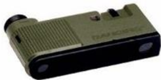
Figura 528. Trena graduada utilizada para aferição do diâmetro dos troncos e telêmetro óptico utilizado para aferição de altura dos indivíduos.
