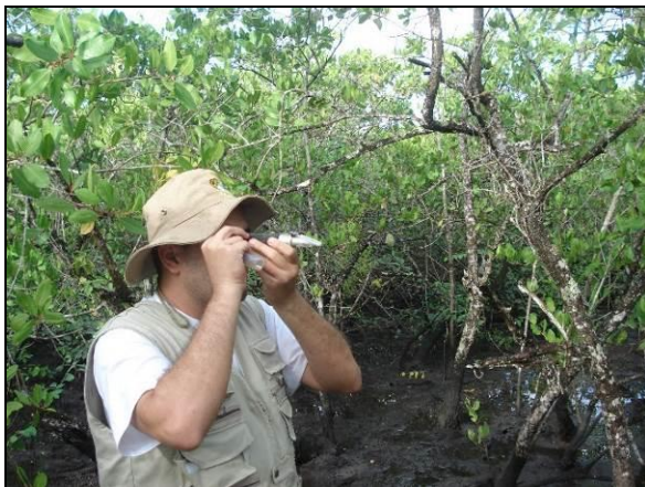
Figura 529. Uso de refratômetro óptico para aferição da salinidade da água intersticial.
