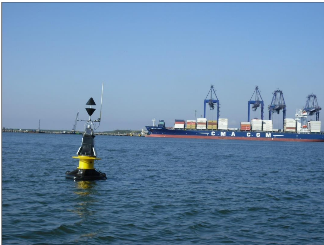
Figura 179. Visão da boia aonde está instalado o perfilador de correntes acústico AWAC ® , em frente ao cais do TCP.
