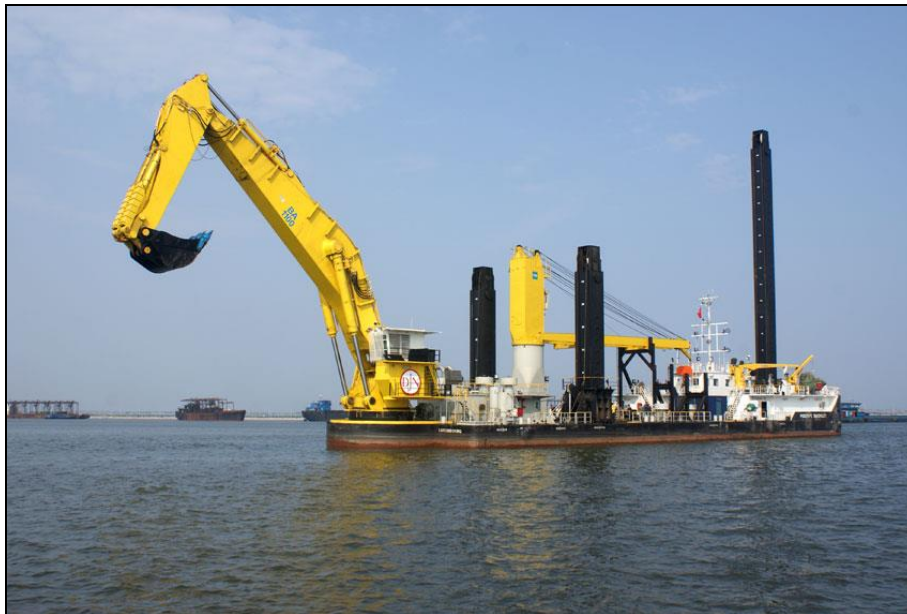
Figura 29. Draga escavadeira tipo backhoe . Detalhe dos três charutos montados na plataforma, dois deles fixados ao substrato para aumento do torque durante escavação. Fonte: jandenul.com.
