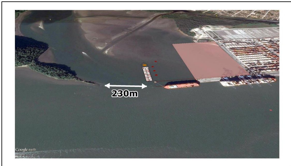
Figura 623. Seção livre do canal da Cotonga com 230 metros. Observa-se o navio atracado nos novos dolphins, oportunidade que haverá uma redução de 40 metros na seção do canal, com a atracação de um navio roll on–roll off .
