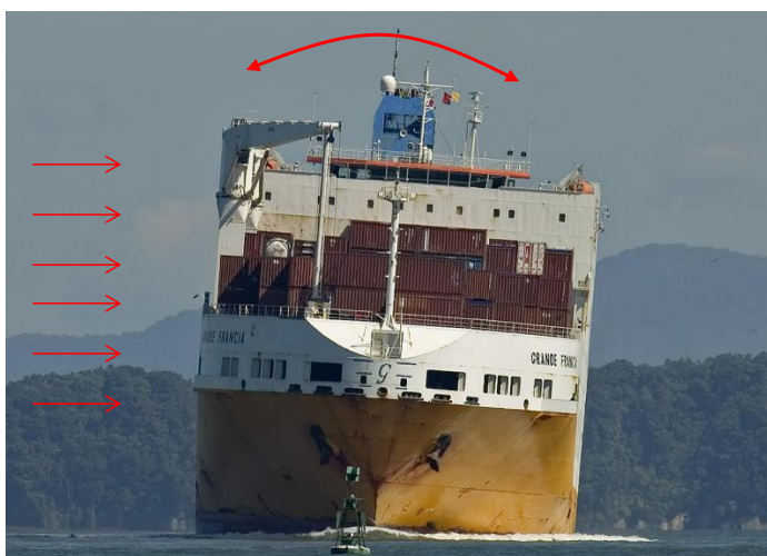
Figura 23 – Inclinação lateral do navio RoRo devido ao vento
