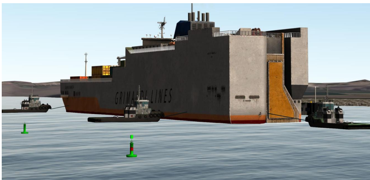
Figura 24 Arranjo utilizado com rebocadores por bombordo
