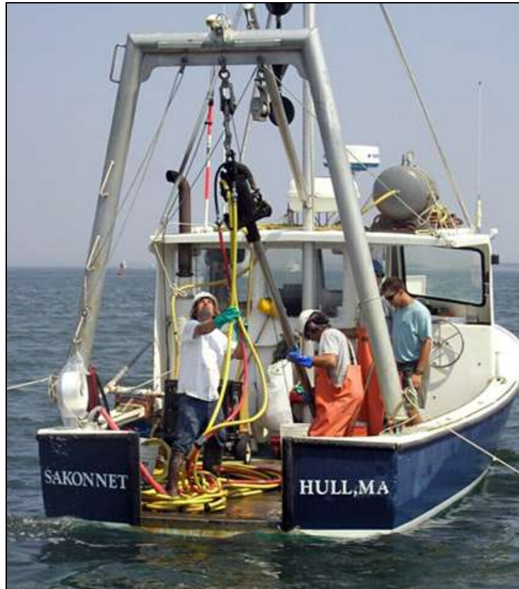
Figura 256. Ilustração de uma embarcação preparada para a amostragem de sedimentos em águas rasas, utilizando a metodologia de vibracore. Fonte: CR Environmental.
