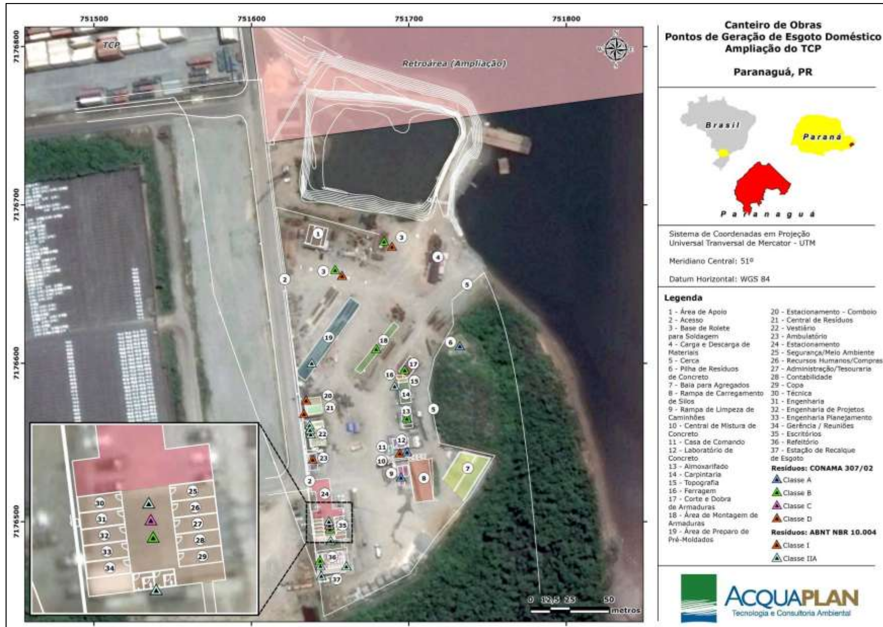
Figura 68. Layout do Canteiro de Obras a ser utilizado no Projeto de Ampliação e mapeamento dos pontos de geração de resíduos sólidos.
