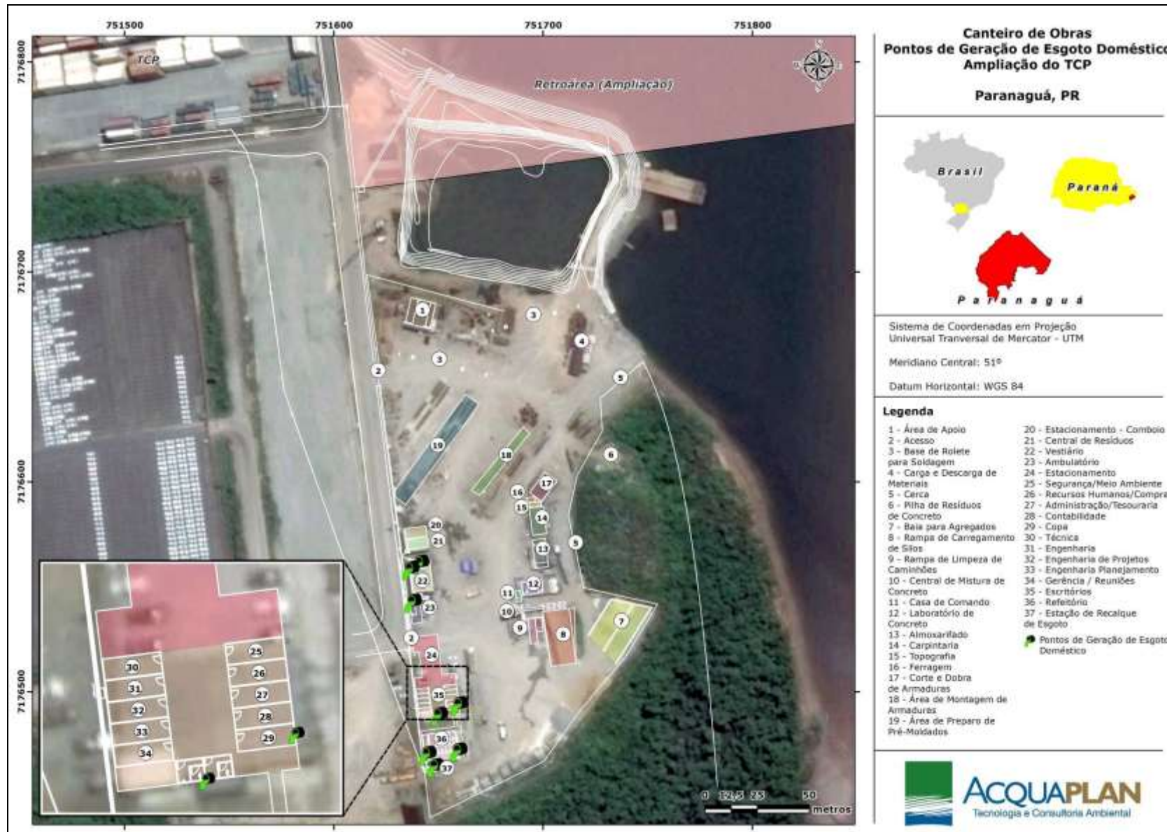
Figura 64. Layout do canteiro de obras destacando os pontos de geração de esgoto sanitário.
