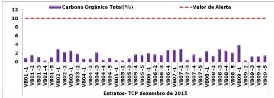
Figura 268. Concentração de carbono orgânico total (mg/kg) de 38 amostras de sedimentos coletadas em 9 testemunhos na área de ampliação do TCP.
