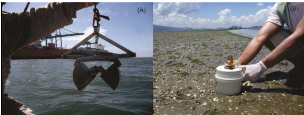
Figura 361. Equipamentos utilizados nas coletas: A) busca fundo do tipo van Veen e B) amostrador cilíndrico de PVC.
