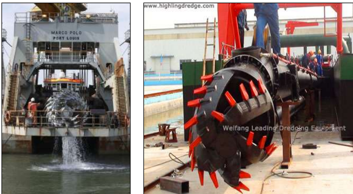
Figura 23. Detalhe da draga de sucção e recalque. Fontes: (E) Jandenu.com e (D) http://www.highlindredge.com/product.asp?leibie=73 .
