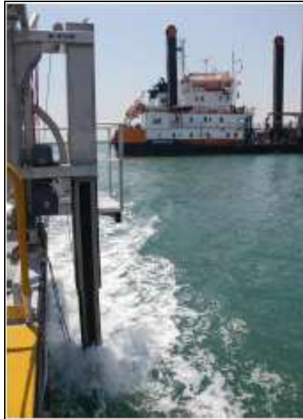
Figura 625. Equipamento instalado em embarcação com função de medir as partículas em suspensão na coluna d'água durante as atividades de dragagem. Fonte: Van Oord (2014).
