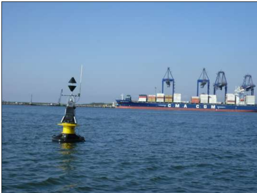
Figura 212. Visão da boia aonde está instalado o perfilador de correntes acústico AWAC®, em frente ao cais do TCP.
