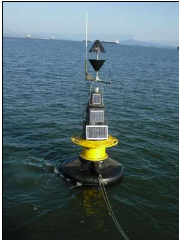
Figura 213. Detalhe da boia aonde está instalado o perfilador de correntes acústico AWAC®.
