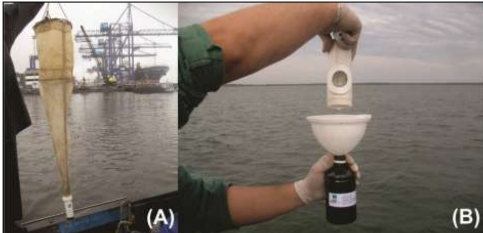
Figura 435. (A) Rede utilizada para a coleta de amostra da comunidade Zooplancônica e, (B) acondicionamento da amostra.
