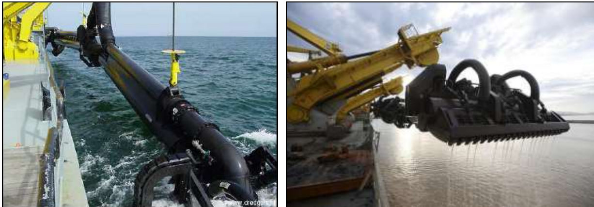
Figura 20. Articulação da tubulação e “boca” de draga hopper. Fonte: (E) dredgers.com e (D) jandenul.com.
