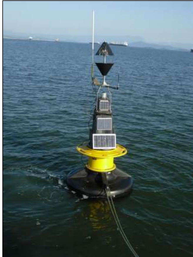
Figura 147. Detalhe da boia do ADCP em frente ao Terminal de Contêineres de Paranaguá - TCP.
