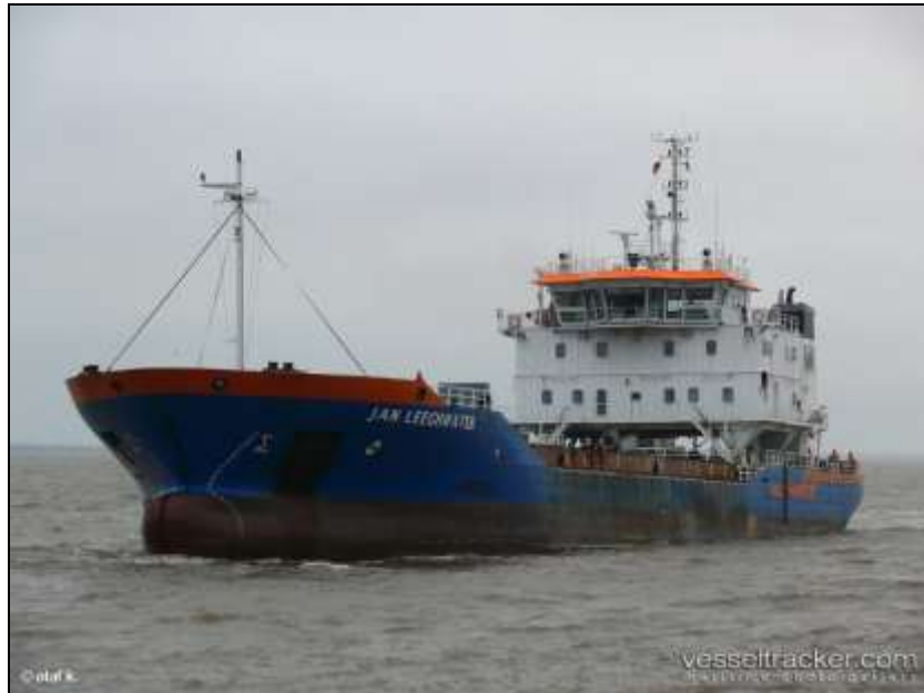
Figura 29. Exemplo de uma barcaça de transporte de material dragado, denominado "batelão". Fonte: vesseltracker.com.
