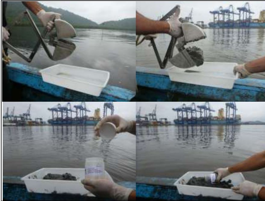
Figura 239. Amostrador do tipo van Veen utilizado na coleta de sedimento superficial.
