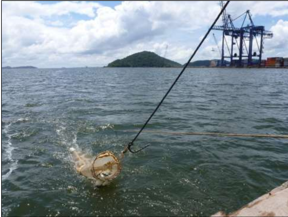
Figura 436. Arrasto da rede ictioplanctônica acoplada com fluxômetro para medir o volume de água filtrado.
