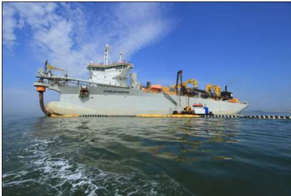
Figura 22. Draga autotransportadora Charles Darwin utilizada durante a dragagem de aprofundamento do Porto de Itajaí, em 2011, com cisterna de capacidade de 30.500 m 3 . Fonte: jandenul.com.
