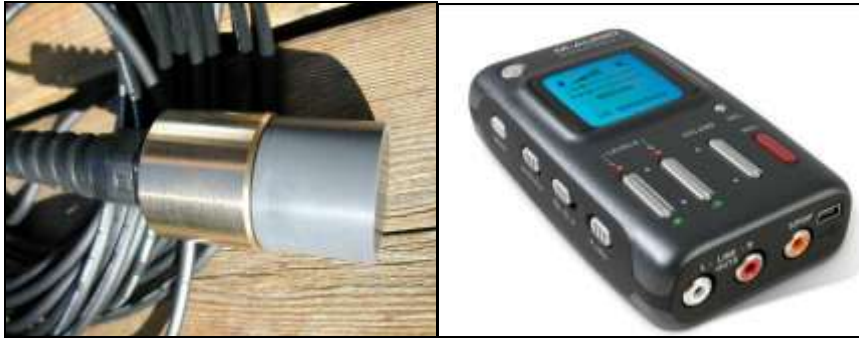
Figura 77. A esquerda o Hidrofone Cetacean Research SQ26-08 , e a direita o gravador digital M-Audio Microtrack II , utilizados para a coleta de dados de acústica na baía de Paranaguá (PR).
