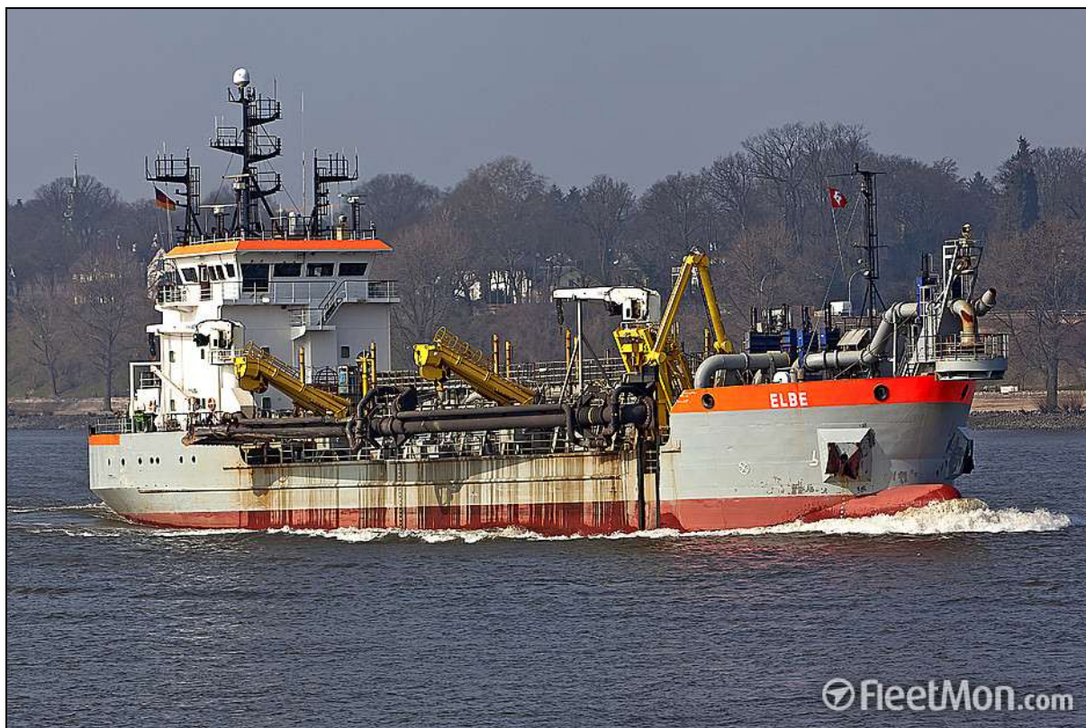
Figura 95. Draga Elbe, pré-selecionada para a execução da dragagem para as obras de complementação da ampliação do TCP.
