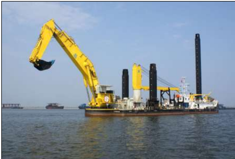
Figura 28. Draga escavadeira tipo backhoe . Detalhe dos três charutos montados na plataforma, dois deles fixados ao substrato para aumento do torque durante escavação. Fonte: jandenul.com.
