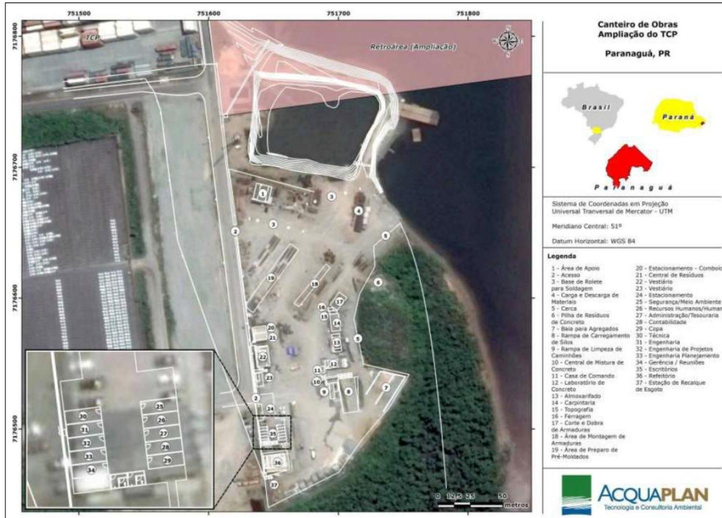
Figura 43. Canteiro de Obras previsto para as obras de ampliação do TCP.
