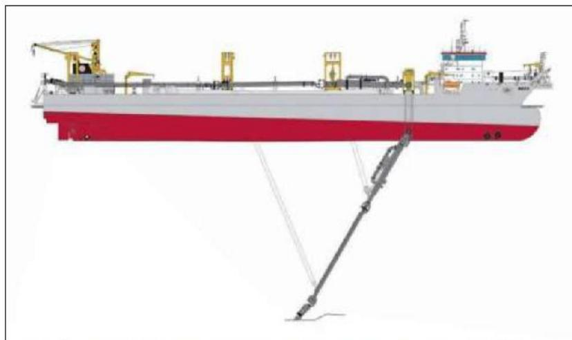
Figura 21. Ilustração de uma draga de sucção por arrasto autotransportadora.
