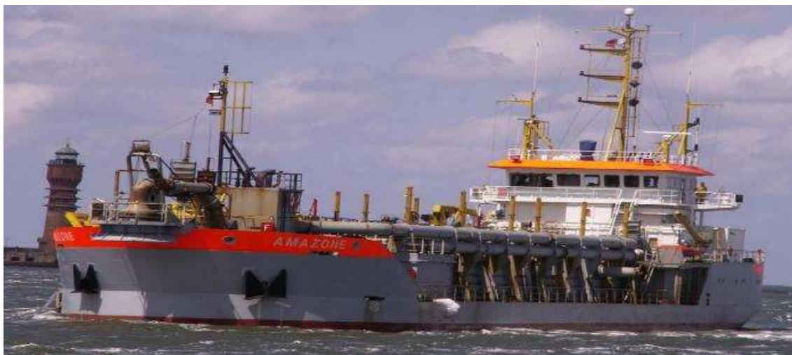
Figura 5.106 – Exemplo de Draga Auto Transportadora
