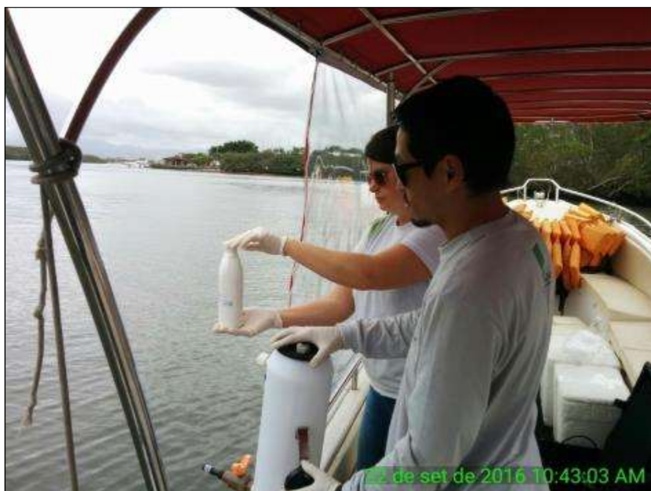
Figura 8.62 – Coleta de amostras de água com o emprego de garrafa a mostradora do tipo van Dorn, na estação amostral #PSF01, durante a 2ª campanha
