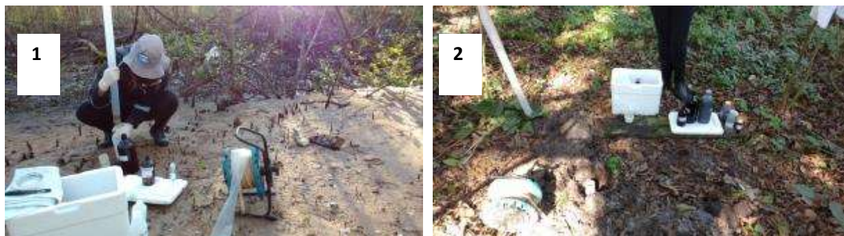
Figura 8.69 – Coleta de amostra sendo realizada no PM-01 (1) e frascaria utilizada no acondicionamento das amostras de água coletadas nos poços de monitoramento (2).
