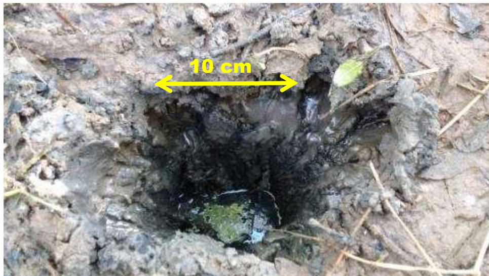
Figura 8.71 – Visualização da camada de argila com matéria orgânica que foi identificada na perfuração para instalação do poço de monitoramento PM-02.
