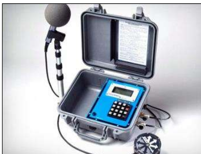
Figura 8.13 – Sismógrafo com geofone e microfone.
