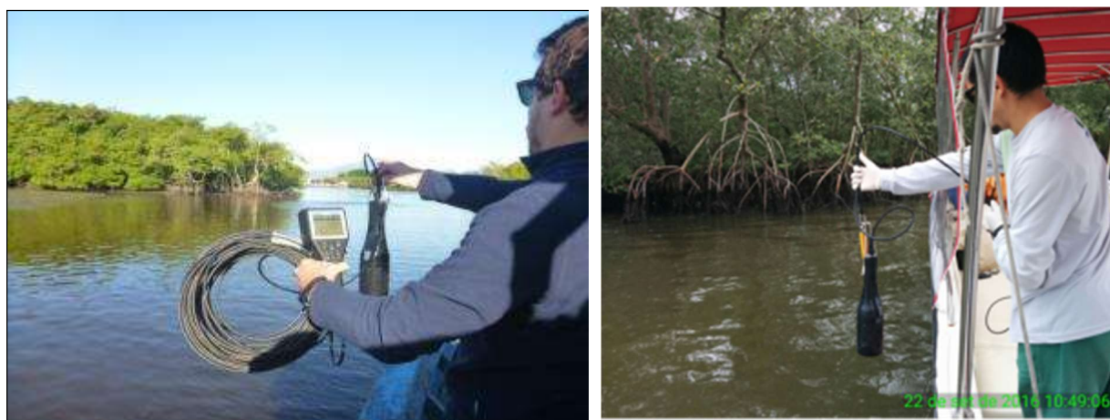
Figura 8.63 – Sonda utilizada na mensuração in situ dos parâmetros físico-químicos, na 1ª e 2ª campanhas.
