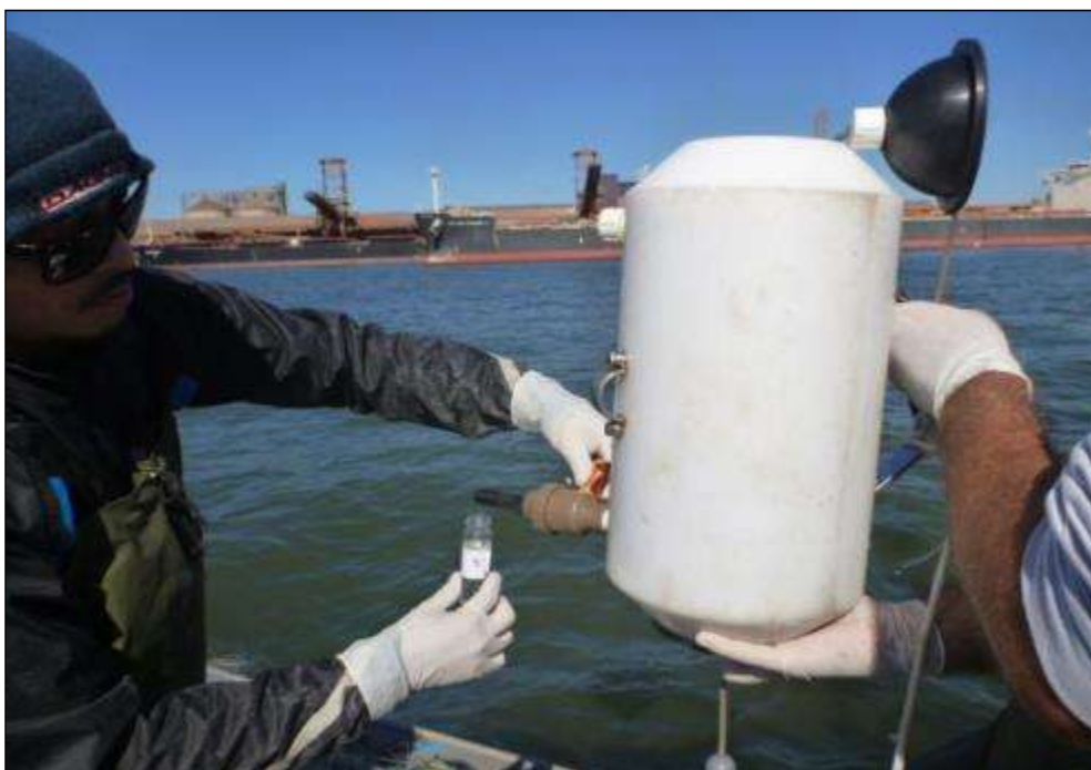
Figura 8.61 – Coleta de amostras de água com o emprego de garrafa a mostradora do tipo van Dorn, na estação amostral #PSF03, durante a 1ª campanha.
