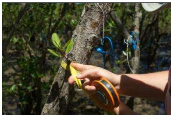
Figura 8.2.2 - Trena graduada utilizada para aferição do diâmetro dos troncos e telêmetro óptico utilizado para aferição de altura dos indivíduos.
