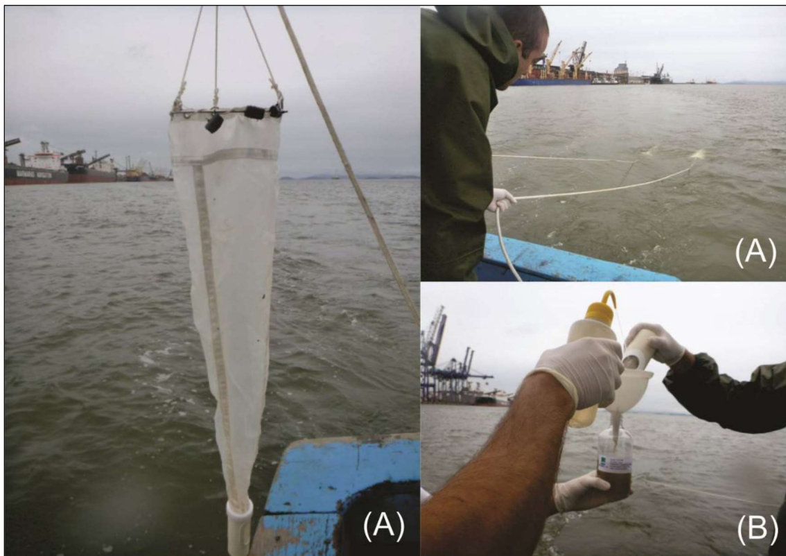
Figura 8.2.40 - Rede utilizada para coleta de amostra da comunidade Zooplanctônica (A), e acondicionamento da amostra (B).
