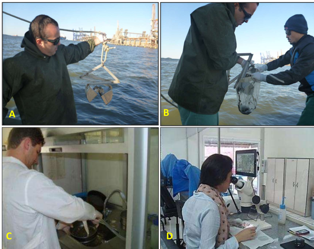
Figura 8.2.44 - A: Busca fundo tipo van Veen utilizado para coleta da macrofauna bêntica; B: Amostras sendo acondicionadas em sacos tela com abertura de malha de 500 micra; C: Triagem das amostras e D: Identificação em microscópio estereoscópio.
