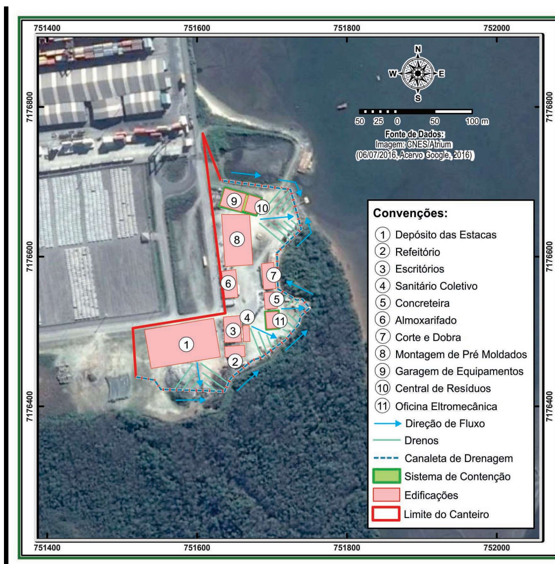
Figura 10.2 – Layout do Canteiro de Obras.
