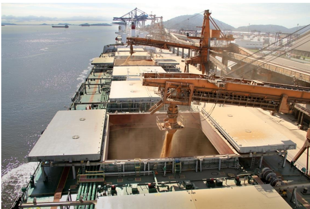
Figura 19. Dois carregadores de navios operando simultaneamente em um mesmo graneleiro
