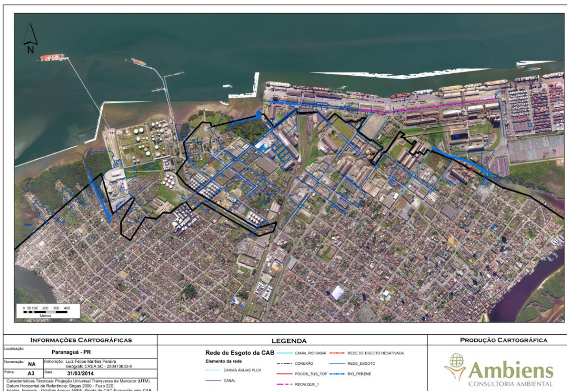
Figura 77. Rede de esgoto sob responsabilidade da CAB
