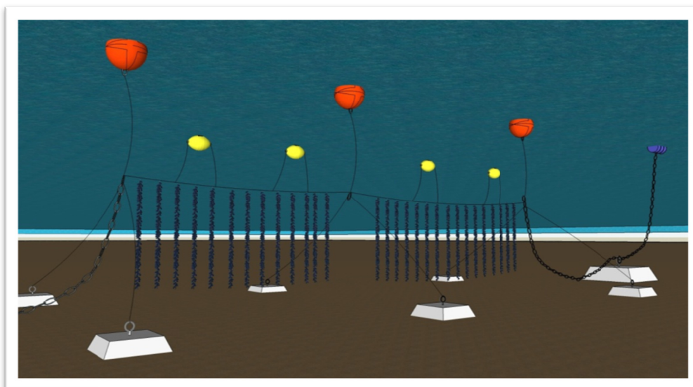
Figura 37 - Representação esquemática de um long-line de meia-água usado em cultivo de moluscos.
