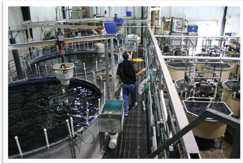
Figura 112 - Sistema de recirculação de água.
