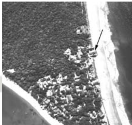
Figura 45 Fotografia aérea vertical de 1999, da parte norte da vila Nova Brasília, onde se observa uma residência avançada sobre a praia (indicada com a seta), que tinha já sido destruída em setembro de 2003.
