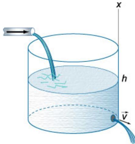
Denotando por  $V = V(t)$  o volume de água dentro do tanque no tempo  $t$ , temos que  $\frac{dV}{dt} = k\sqrt{h}$ ,  $k$  constante. Mostre que se a altura inicial do líquido em relação ao orifício é  $h_0$  então a altura do líquido  $h(t)$ , conhecida a vazão  $V(t)$ , em um tempo  $t$  qualquer, é solução da equação diferencial
