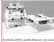
Restituidor ZEISS, modelo Planicart, com a mesa traçadora (aparelho de 1º Ordem de precisão)
