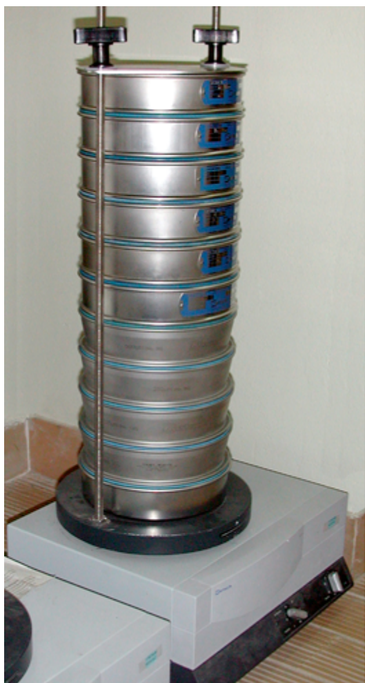
Fig. 15 - Agitador de peneiros e coluna de peneiração utilizados no CIACOMAR (Univ. Algarve).
