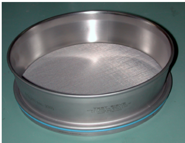
Fig. 13 - Peneiro utilizado em análise granulométrica. Neste caso trata-se de peneiro com rede inox de 62 \mu .
