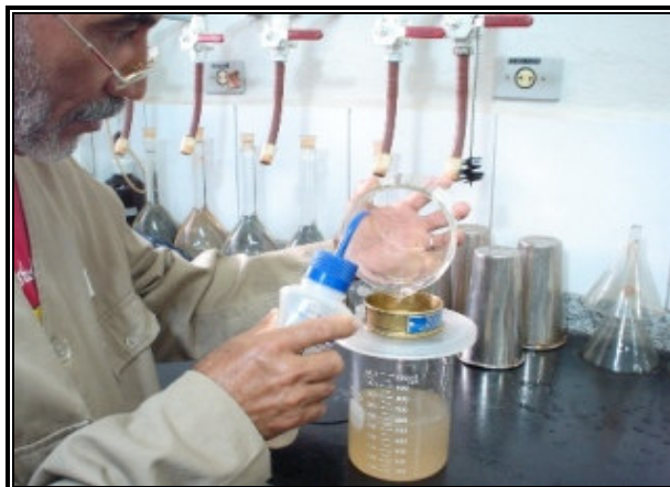
Foto 20 – Passagem da amostra na peneira 0,0625 mm, para separação da areia do silte+argila
