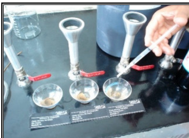
Foto 23 – Adição da solução de Peróxido de Hidrogênio para separação do material orgânico contido na amostra
