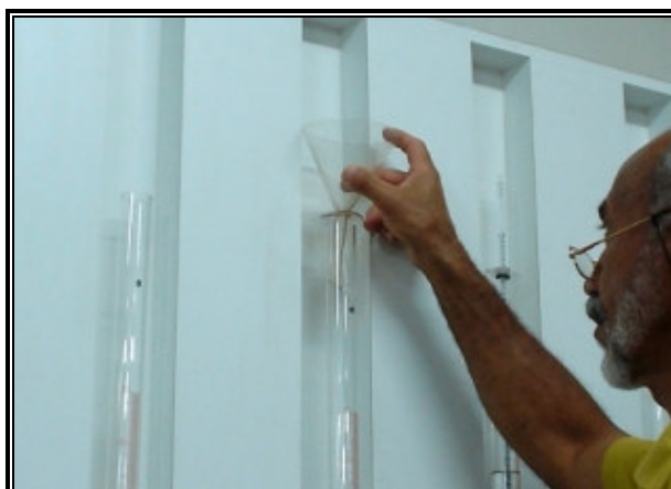
Foto 34 – Colocação do funil na boca do tubo
