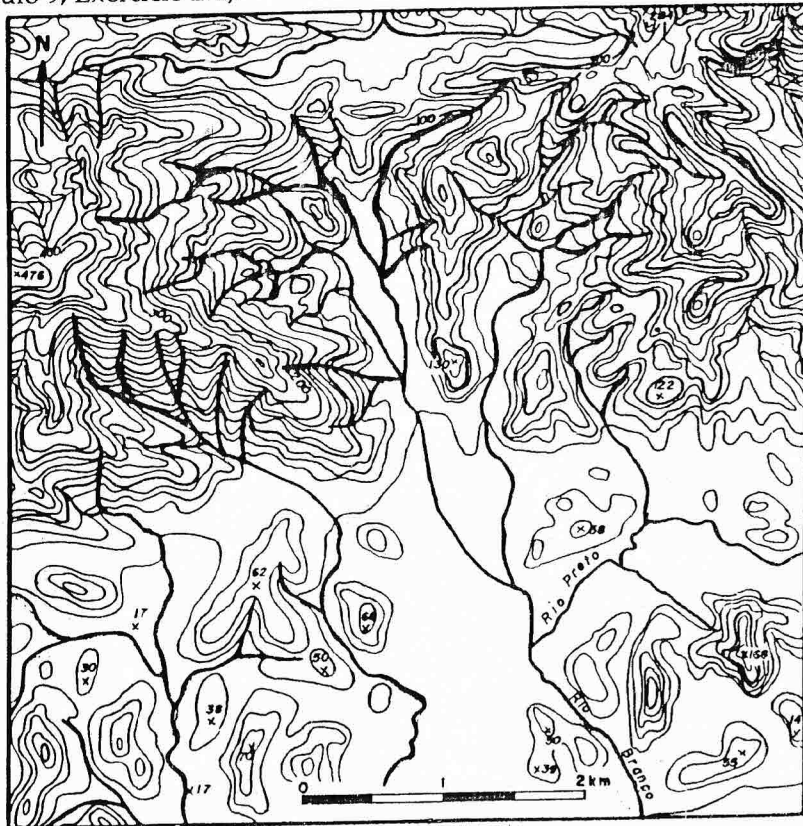
Figura 5.14 — Rede de drenagem localizada na carta topográfica de Casimiro de Abreu, indicada para o traçado do perfil longitudinal. Equidistância das curvas de níveis: 20m.
