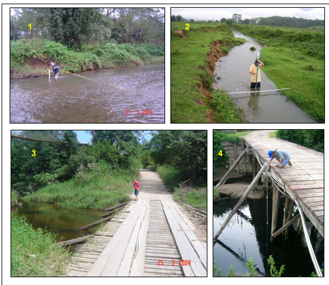
Figura 43: exemplos de situações de construção da seção dos rios e medição de vazões: no interior do canal (1- rio Pirabeiraba, 2- rio Cupim); em pontes baixas (3- rio Três Barras); em pontes altas (4- rio do Braço). Fotos: F.A.Oliveira, 2004-2006.
