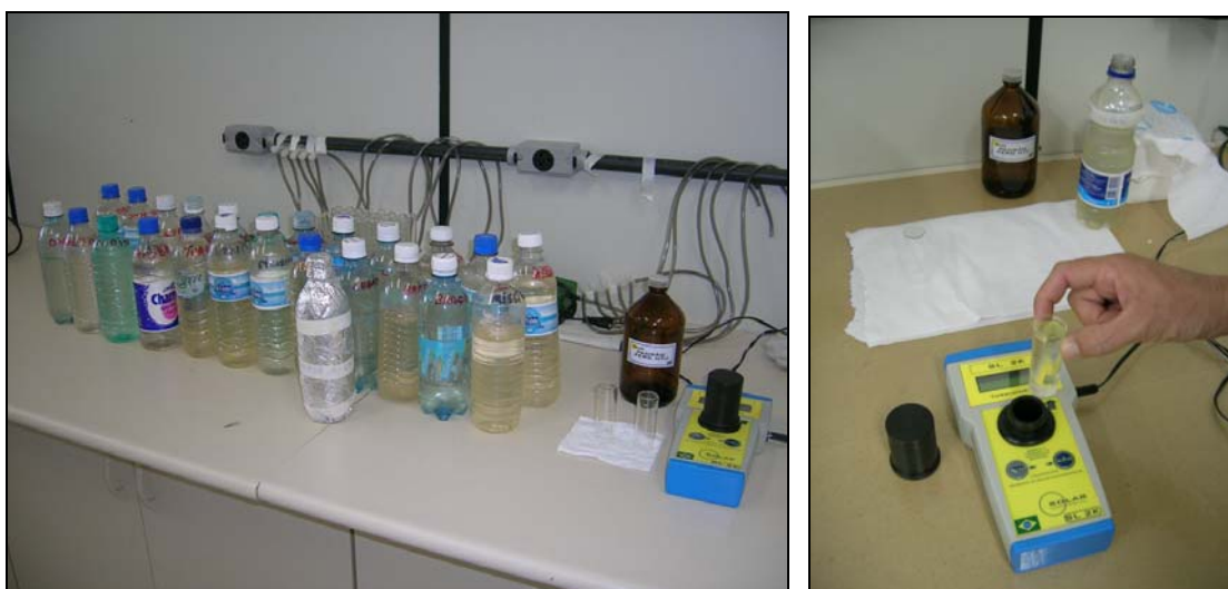
Figura 45: procedimento de leitura de turbidez em bateria de amostras. Fotos: F.A.Oliveira, 2006.
