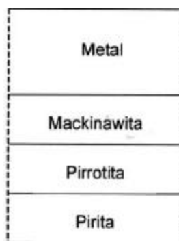
FIGURA 43 – SEQÜÊNCIA DE FORMAÇÃO DE SULFETOS DE FERRO EM SOLUÇÃO DE ÁGUA DESTILADA COM H_2S NAS CONDIÇÕES DO EXPERIMENTO DE MEYER (1958)
