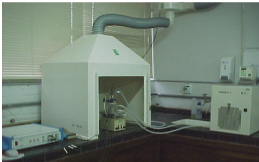
FIGURA 58 – VISÃO GERAL DO LOCAL DE TESTES; DA ESQUERDA PARA A DIREITA: POTENCIOSTATO, AGITADOR E CÉLULA SOB EXAUSTÃO DE GASES E BANHO TERMOSTÁTICO
