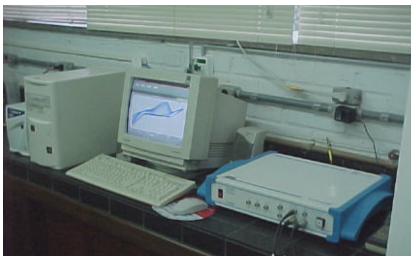
FIGURA 59 – SISTEMA DE AQUISIÇÃO DE DADOS: VOLTALAB 10 CONTROLADO POR SOFTWARE VOLTAMASTER 4
