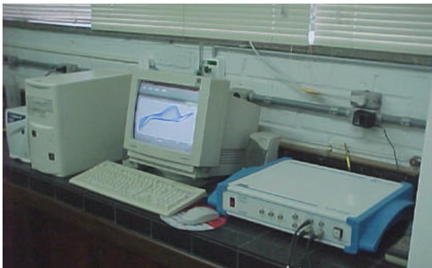
FIGURA 59 – SISTEMA DE AQUISIÇÃO DE DADOS: VOLTALAB 10 CONTROLADO POR SOFTWARE VOLTMASTER 4
