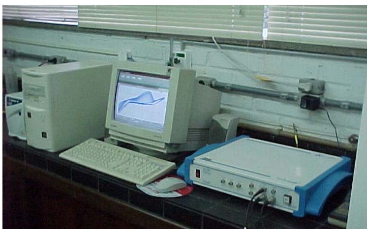
Figura 20 – Potenciostato e sistema de aquisição de dados
