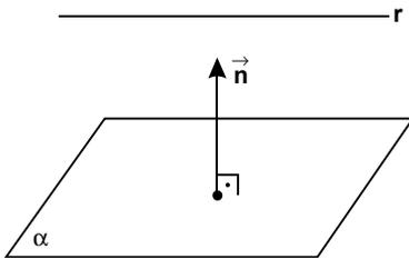
O vetor  $\vec{n} = a\vec{i} + b\vec{j} + c\vec{k}$  é ortogonal ao plano  $\alpha$  e  $\vec{r} = \ell\vec{i} + m\vec{j} + n\vec{k}$  tem a direção da reta  $r$ , esta paralela ao plano  $\alpha$ . Isto posto, a condição de paralelismo entre a reta  $r$  e o plano  $\alpha$  se faz com a aplicação da condição de ortogonalidade entre os vetores  $\vec{n}$  e  $\vec{r}$ :
