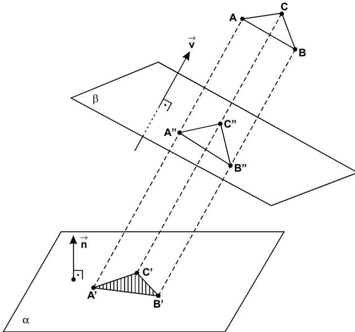
Seja  $\alpha$  um plano orientado pelo vetor  $\vec{n}$ , unitário e a ele ortogonal. Procura-se a área da projeção do triângulo  $ABC$  sobre o plano  $\alpha$ , segundo a direção do vetor  $\vec{v}$  (representada na figura por  $A'B'C'$ ).
