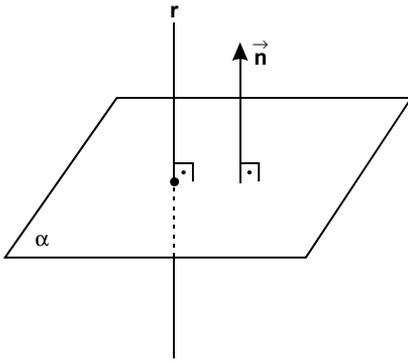
A reta  $r$  sendo ortogonal ao plano  $\alpha$ , tem a direção do vetor  $\vec{n} = a\vec{i} + b\vec{j} + c\vec{k}$ . Da condição de paralelismo entre dois vetores:
