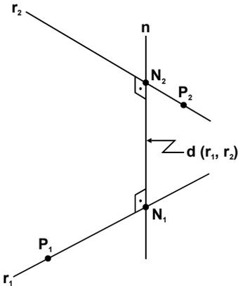
A reta  $r_1$  é passante por  $P_1 = (x_1, y_1, z_1)$  e é paralela ao vetor  $\vec{r}_1 = \ell_1 \vec{i} + m_1 \vec{j} + n_1 \vec{k}$ . A reta  $r_2$  contém o ponto  $P_2 = (x_2, y_2, z_2)$  e tem a direção do vetor  $\vec{r}_2 = \ell_2 \vec{i} + m_2 \vec{j} + n_2 \vec{k}$ .
