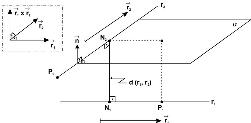
Seja  $\alpha$  um plano auxiliar que contém a reta  $r_2$  e é paralelo à reta  $r_1$ . Destarte, a distância  $d(r_1, r_2)$  entre as retas  $r_1$  e  $r_2$  é a distância de um ponto de  $r_1$  ao plano  $\alpha$ . Na figura:
