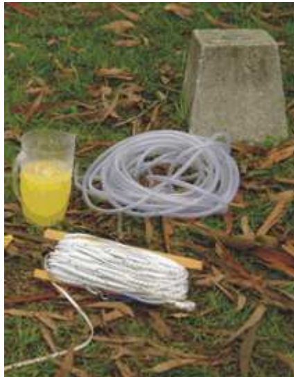
Figura 2.12 – Mangueira e acessórios para o nivelamento de mangueira.
