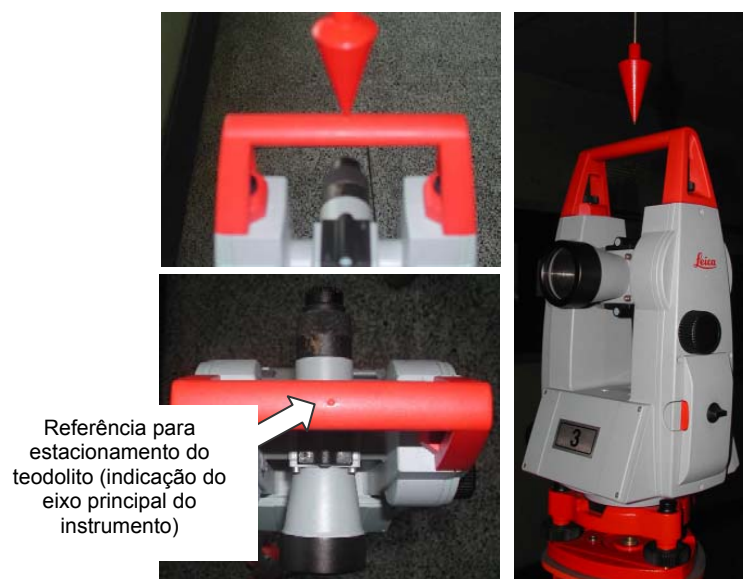
Figura 3.5 - Centragem do teodolito com fio de prumo no teto.
