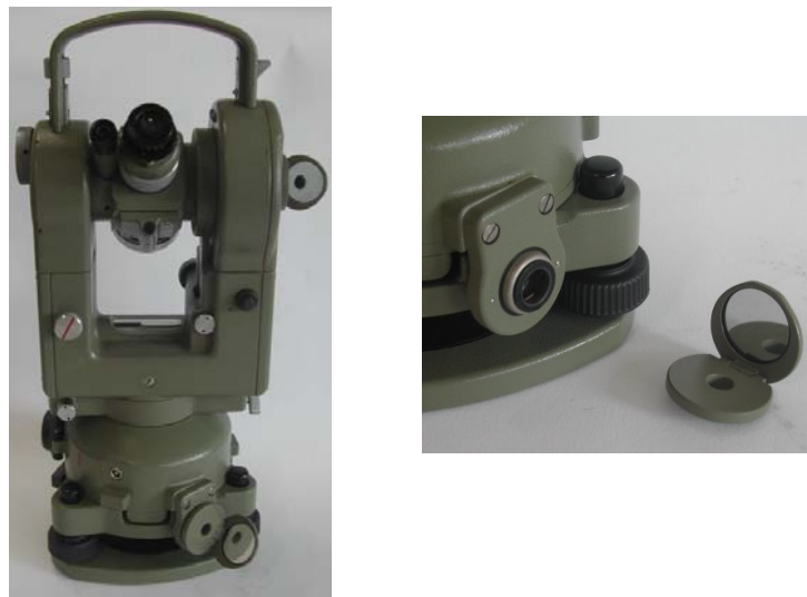
Figura 1.3 – Conjunto de espelhos de um equipamento óptico-mecânico (modelo Wild T2).
