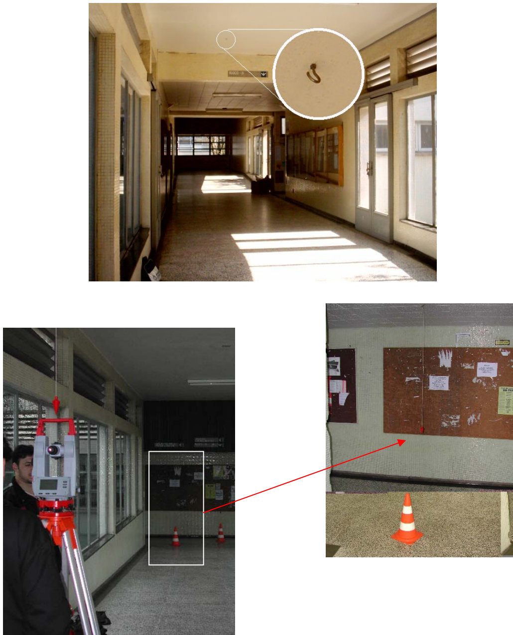
Figura 5.17 - Medição de um dos lados da poligonal, onde os dois pontos estão no teto.
