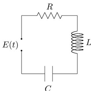
a equação (4) ainda não é uma EDO, pois contém duas funções,  $I(t)$  e  $q(t)$ . Existem duas formas de obter uma EDO. Uma delas é usando que  $I = \frac{dq}{dt}$ ,
