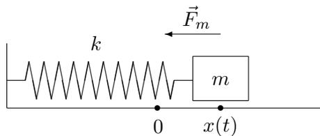
formado por uma massa  $m$  presa a uma mola de constante de elasticidade  $k$  e que realiza oscilações em torno de uma posição de equilíbrio. Colocamos a coordenada  $0$  na posição de equilíbrio. Em cada instante  $t$  a massa ocupa a posição de abscissa  $x = x(t)$ . Várias forças agem sobre a massa. Uma delas é a força restauradora elástica  $F_m$ , devida à ação da mola. O sentido desta força é contrário ao do deslocamento  $x$  e seu módulo é diretamente propor-
