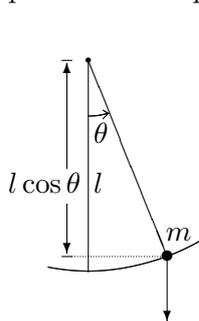
$$\theta' = \frac{d\theta}{dt} = \text{velocidade angular}, \quad l\theta' = \text{velocidade}$$
