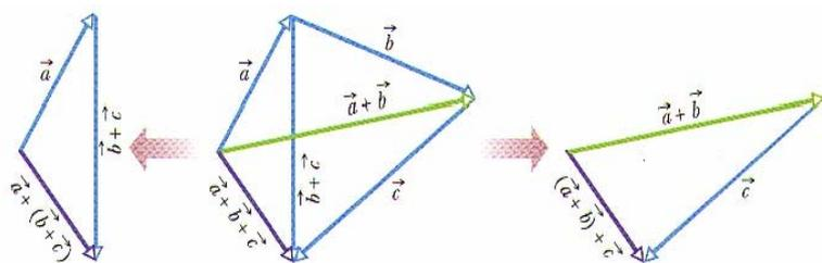
FIG. 3-4 Os vetores  $\vec{a}$ ,  $\vec{b}$  e  $\vec{c}$  podem ser agrupados em qualquer ordem para serem somados;
