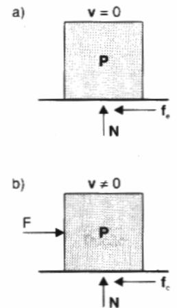
**Figura 3.29** Corpo de peso  $P$  em repouso (a) e em movimento (b); as forças de atrito são, respectivamente, a estática  $f_e$  e a cinética  $f_c$ .
