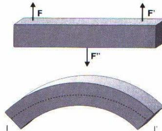
**Figura** Corpo submetido a esforço de flexão.
