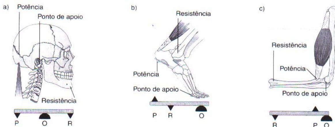
**Figura 3.36** Três tipos de alavanca.  $\mathbf{P}$  é uma força aplicada para equilibrar ou erguer a força resistente  $\mathbf{R}$ .
