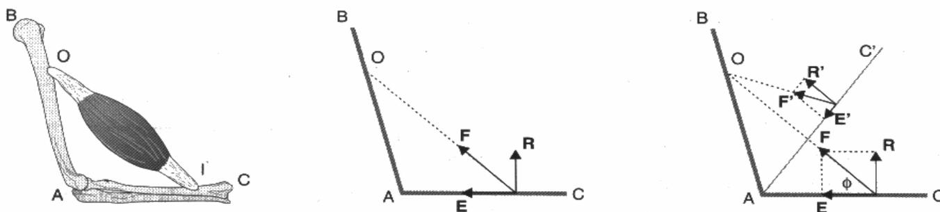
**Figura 3.34** Músculo com origem O e inserção I, atuando sobre os ossos AB e AC.  $R$  e  $E$  são respectivamente os componentes rotador e estabilizador da força muscular  $F$ . Quando o osso AC muda para a posição  $AC'$ , o ângulo de tração  $\phi$  da força  $F'$  aumenta, sendo de  $R' > R$  e  $E' < E$ .
