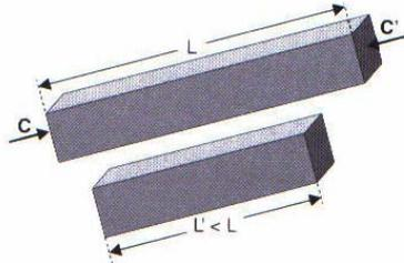
**Figura** Corpo de comprimento  $L$ , submetido a esforço de compressão.
