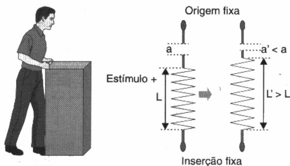
**Figura 3.32** Pessoa tentando deslocar um objeto fixo no chão. Contração muscular isométrica: os elementos elásticos tendem a se alongar e os contráteis a se encurtar. O comprimento da fibra muscular não se altera.
