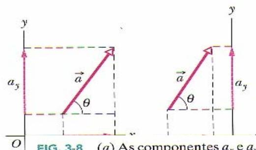
FIG. 3-8 (a) As componentes  $a_x$  e  $a_y$  do vetor  $\vec{a}$ . (b) As componentes não mudam quando o vetor é deslocado, desde que o módulo e a orientação sejam mantidos.
