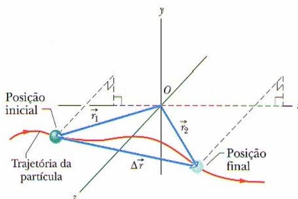
**FIG. 4-2** O deslocamento  $\Delta\vec{r} = \vec{r}_2 - \vec{r}_1$  vai da extremidade do vetor correspondente à posição inicial,  $\vec{r}_1$ , até a extremidade do vetor correspondente à posição final,  $\vec{r}_2$ .
