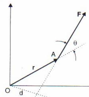
**Figura 3.35** Força  $\mathbf{F}$  produzindo um momento  $\mathbf{M}$  em relação ao ponto fixo  $O$ .
