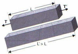
**Figura** Corpo de comprimento  $L$ , submetido a esforço de tração.
