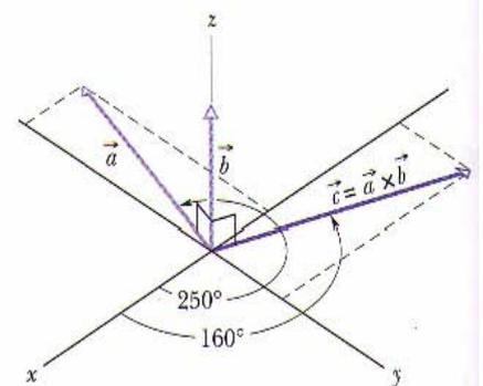
FIG. 3-22 O vetor  $\vec{c}$  (no plano  $xy$ ) é o produto vetorial dos vetores  $\vec{a}$  e  $\vec{b}$ .
