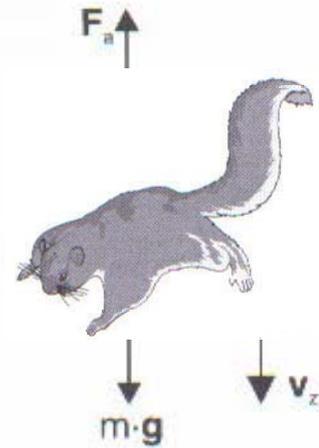
a) Um corpo com massa  $m$  experimenta uma força de arraste  $F_a$ ; b) no caso de baixas velocidades,  $v_z$  tende a um valor limite  $v_L$ ; c) a aceleração  $a \rightarrow 0$  quando  $F_a \rightarrow m \cdot g$ .
