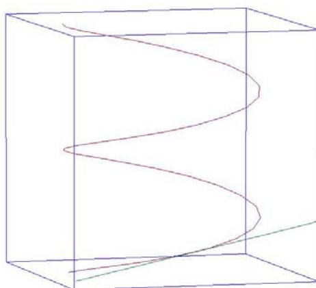
Figura 9.36: Traço da hélice e da reta tangente.
