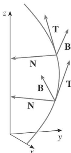
A Figura 9.37 ilustra o Exemplo 9.2.5 mostrando os vetores  $T$ ,  $N$  e  $B$  em dois pontos da hélice circular. Em geral, os vetores  $T$ ,  $N$  e  $B$  começando nos vários pontos, formam um conjunto de vetores ortogonais, denominados triedro  $TNB$ , que se move ao longo da curva quando  $t$  varia.
