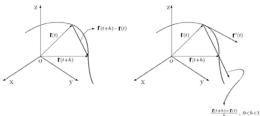
Figura 9.34: Vetor Secante (Figura à esquerda) e Vetor Tangente (Figura à direita).
