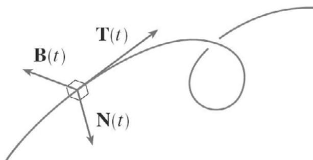
Figura 9.35: Vetores tangente, normal e binormal.
